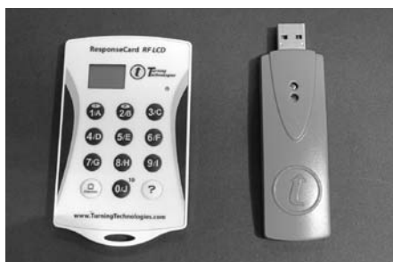
写真1 KEEPAD Japan 社製「クリッカー」端末（左：端末、右：受信機）
