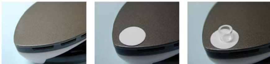
図 4-10 メンブランフィルターのアクリルパイプへの圧着方法。約 110℃に熱した小型アイロンのコテにメンブランフィルターを乗せ、アクリルパイプを 2～5 秒間押しつけて熱圧着した。
