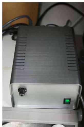
図 4-53 開発したパルス LED 光源の写真。(a)照射レンズも含めた光源全体の写真。(b)電源および制御回路を納めたケースの写真。切り換えスイッチによって、パルス点灯時間を 1 \sim 5 \mu\text{s} の間で 1 \mu\text{s} 単位で切り換えて使用できる。
