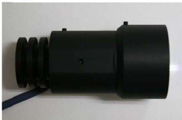
図 4-53 開発したパルス LED 光源の写真。(a)照射レンズも含めた光源全体の写真。(b)電源および制御回路を納めたケースの写真。切り換えスイッチによって、パルス点灯時間を 1 \sim 5 \mu\text{s} の間で 1 \mu\text{s} 単位で切り換えて使用できる。
