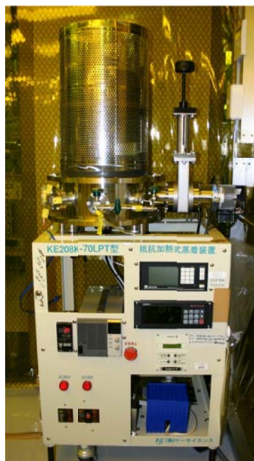
図 2-6 抵抗加熱蒸着装置。(a) 抵抗加熱法による蒸着原理。蒸着作業に先立ち、成膜したい処理基板をベルジャー上方に設置し、蒸着材料をタングステンバスケットに入れバスケットの両端を直流電源の回路にしっかり固定する。この時、処理基板手前のシャッターを閉じた状態にしておく。その後ベルジャー内を真空引きし、真空度が 10^{-5} \sim 10^{-6} Torr 程度に到達したらタングステンバスケットに数十 A の電流を流し、蒸着材料が溶け始めたら水晶振動子の膜厚計を見ながら蒸着材料に合った成膜速度になるよう電流量を調整する。最適な成膜速度になったことを確認したらシャッターを開け、必要な膜厚に到達したところでシャッターを閉じる。(b) 本研究で使用した蒸着装置。
