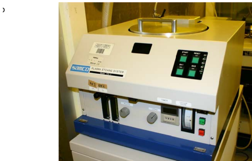
図 2-5 プラズマエッチング装置。(a) 試料チャンバーの模式図。試料チャンバー内を真空にした後に反応ガスを導入し、平面電極と対向電極間に高周波電圧を印加すると電極間にプラズマが発生する。プラズマ中の電子は、活性ガスであるプラスイオンに比べて軽く動きが速いため、対向電極と平面電極にすぐに集まる。集まった電子は、対向電極ではアースに接続されているために電位は変わらないが、平面電極はブロッキングコンデンサによって直流の電流が遮断されてしまうため平面電極に電子が溜まりマイナス電位になる。この陰極降下のマイナス電位により、プラズマ中の活性ガスであるプラスイオンが引かれて、ウエハ表面に垂直に入射するため異方性エッチングが行われる。(b) 本研究で使用したプラズマエッチング装置。
