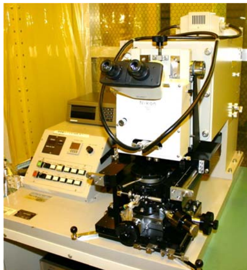
図 2-4 コンタクト式露光装置。(a) フォトマスクを露光装置に、フォトレジストが塗布された処理基板を位置決めテーブルにそれぞれ固定した後、アライメントスコープに取り付けられた接眼レンズを覗きながら位置決めテーブルを動かしてフォトマスクとの位置合わせを行う。(b) フォトマスクと処理基板を密着させた後アライメントスコープ全体を傾け、超高圧水銀灯の紫外光を投光用ミラーに反射させて露光する。(c) 本研究で使用した露光装置。
