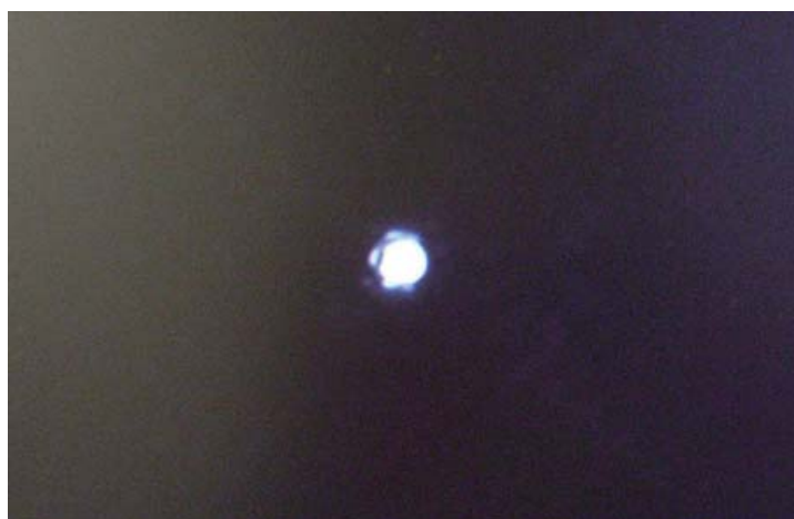
図 7.13 フォトニックバンドギャップファイバー出射面の NFP 赤外カメラで撮影
