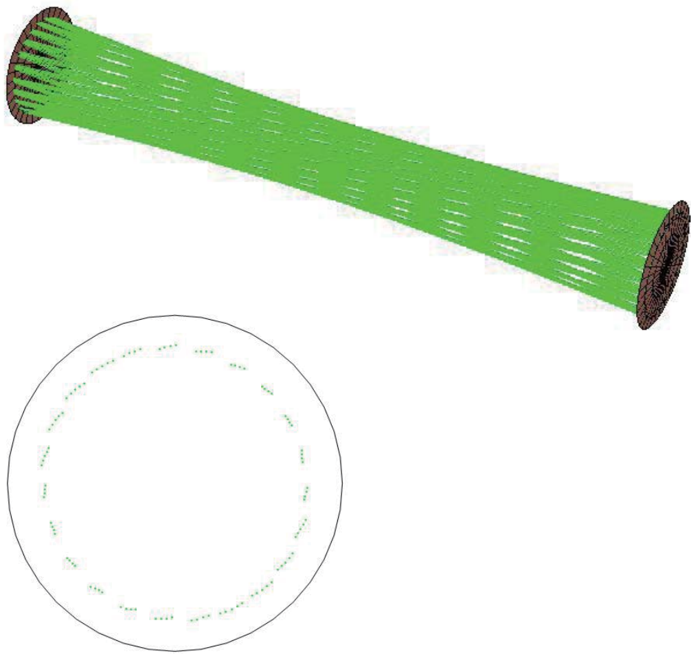
図 4.7 マルチパスセルの光線追跡例
