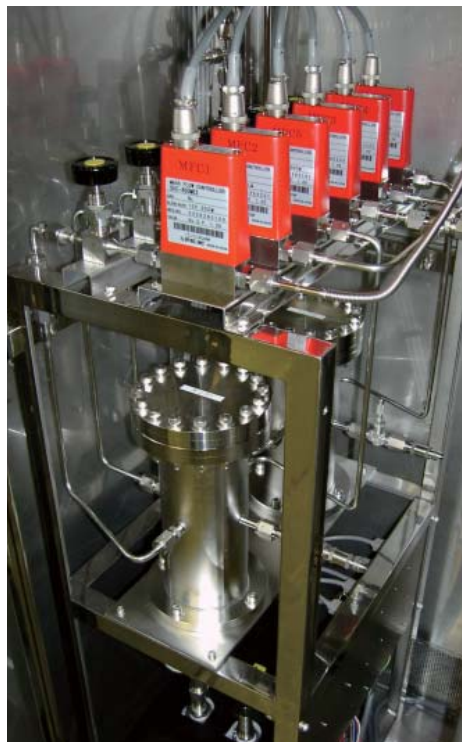
図 4.2 標準ガス発生装置の外観 (左) と混合部 (右)
