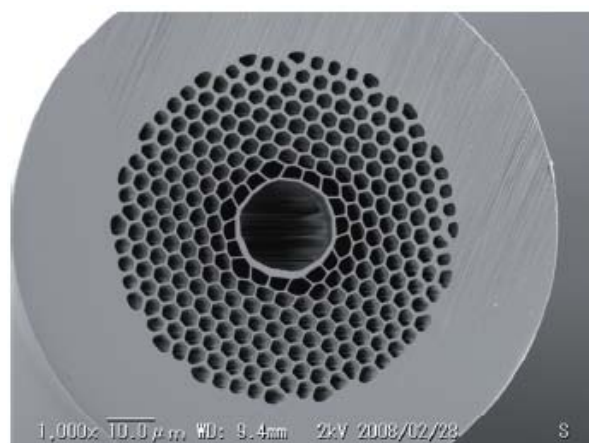
図 6.1 フォトニックバンドギャップファイバーの断面例
