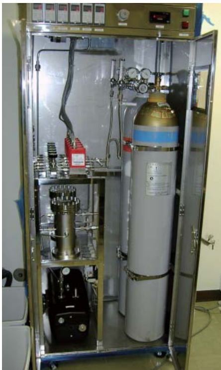
図 4.2 標準ガス発生装置の外観 (左) と混合部 (右)
