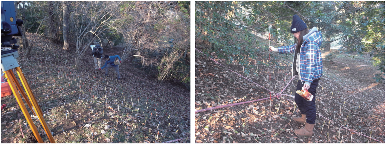
図5 測量作業（地区割・測距・カラーピンポール）の様子
