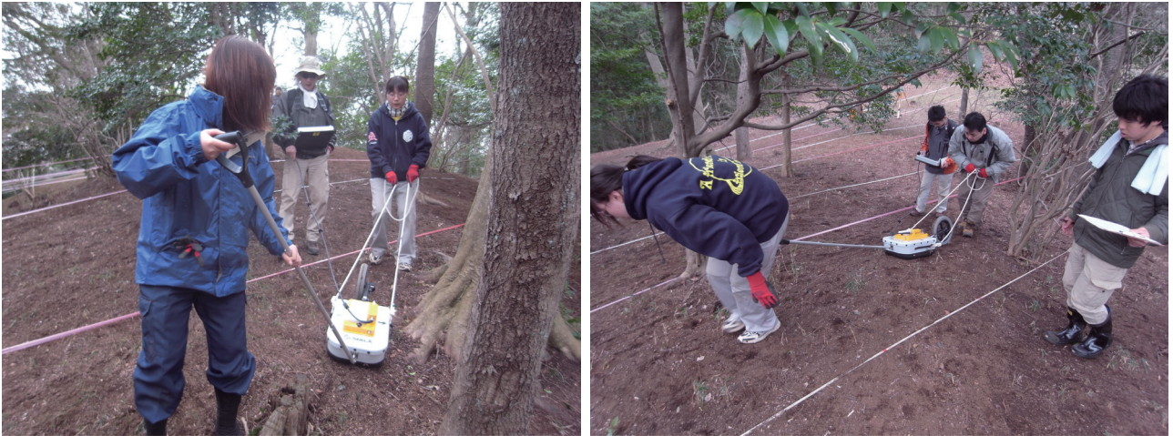
図9 GPR作業の様子
