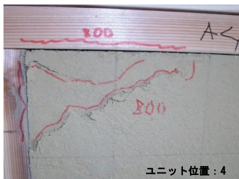
図4-31 原波加振後の損傷状況
