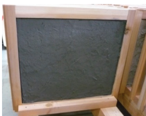
図2-13 荒壁土塗り後の乾燥前後比較
