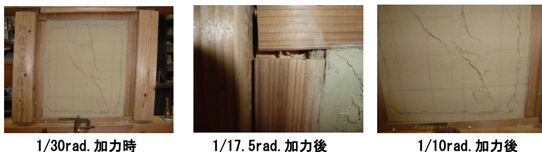
図 2- 36 固定有り試験体の損傷状況
