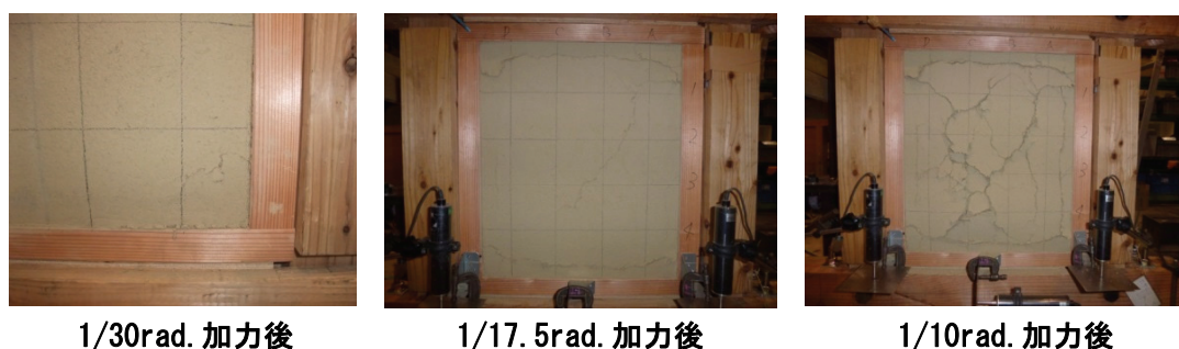
図 2- 35 固定無し試験体の損傷状況
