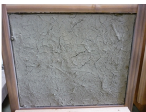
図2-13 荒壁土塗り後の乾燥前後比較
