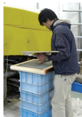
図 2- 8 壁土塗り作業
