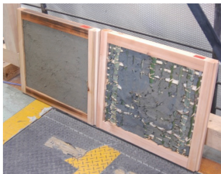
図 2- 9 片面荒壁土塗付け後
