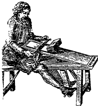
Abziehen eines Werkstücks, 18. Jahrhundert Der beidhändig geführte Ziehklingenhobel dient der feinen Oberflächenglättung aus: A.J. Roubo, Bd. IV, Taf. 350
