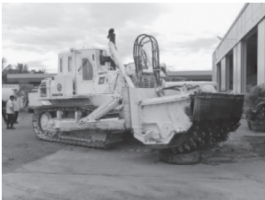
写真 14 地雷処理車側面から 右が前
