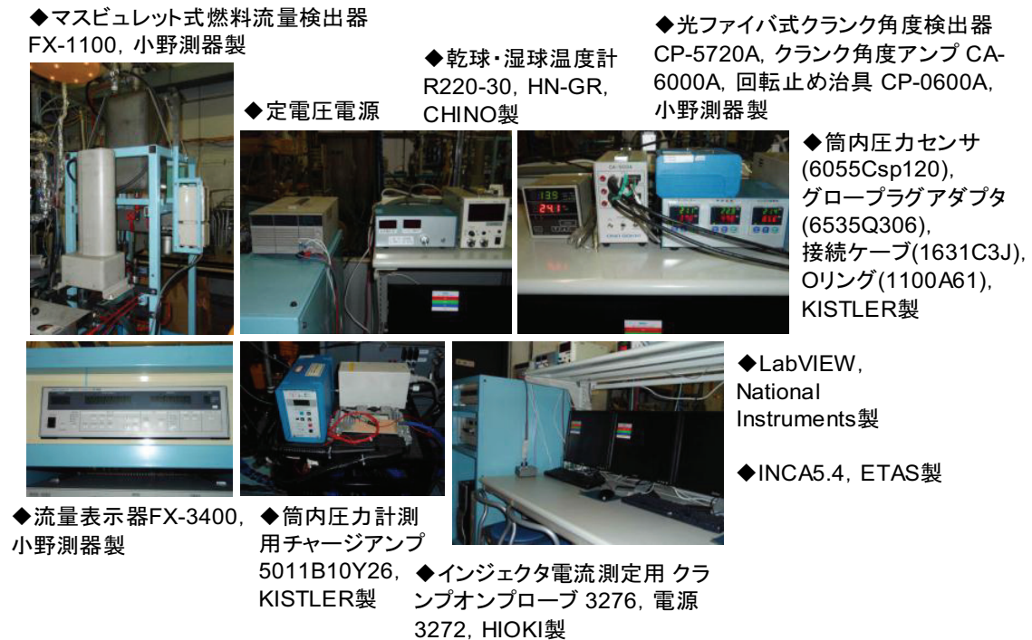
図2.9 実験装置(早大 第3機関室)
