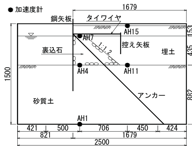
図-4.17 せん断波速度の算定に使用した加速度計設置位置
