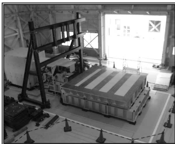
写真4-1 振動台の全景
