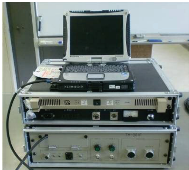
図 2.2.10 計測システムの写真 左上 発振器、右上 受信器、下 データロガーと増幅器
