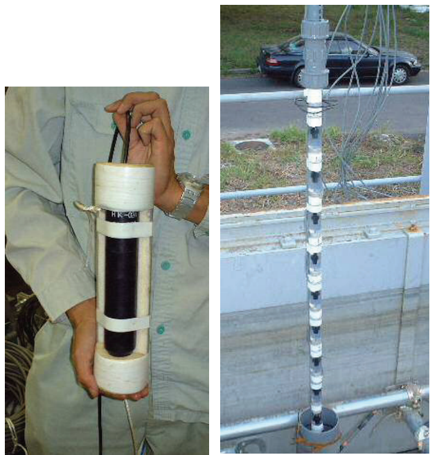
図 5.2.4 使用した発振器(左)と受信器(右) 6)
