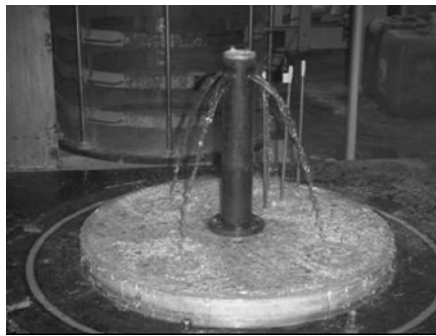
注入管 (通水状況)
