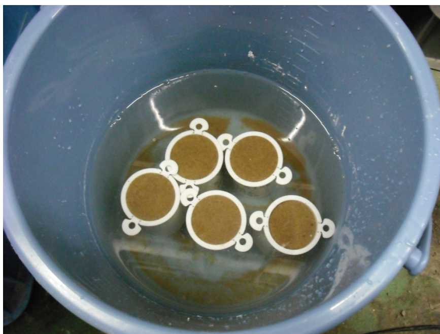
写真 5-2 供試体の水中養生の様子
