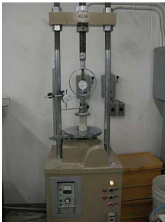
写真 5-3 一軸圧縮試験装置の全容
