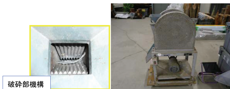
図 5.3.1 小型粉碎機と破碎部機構
