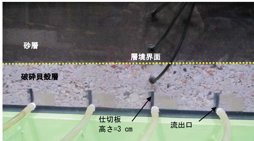
図 6.2.5 大型実験土層内の破碎した貝殻の敷設状況
