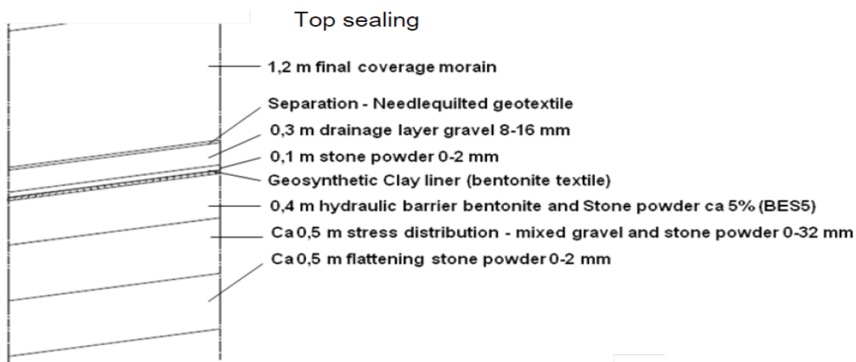
図 2.3.5 上部の覆土構造図 7)
