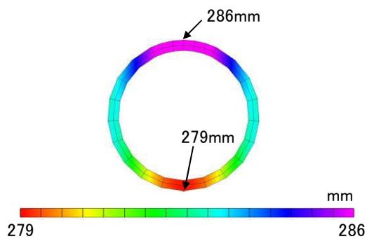
図-4.12 内空変位計測断面鉛直変位分布図（等分布荷重 150kPa）
