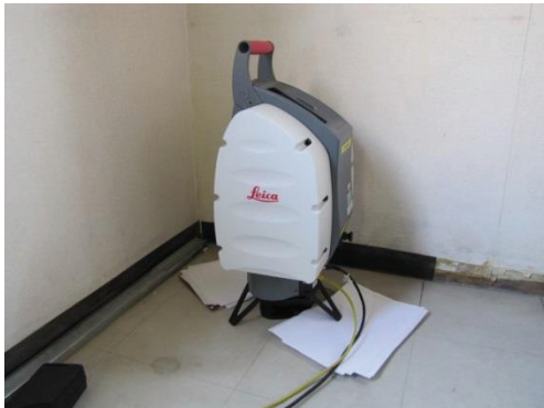
写真 4.6 三脚なしでS2の位置に据え付けられたスキャナー
