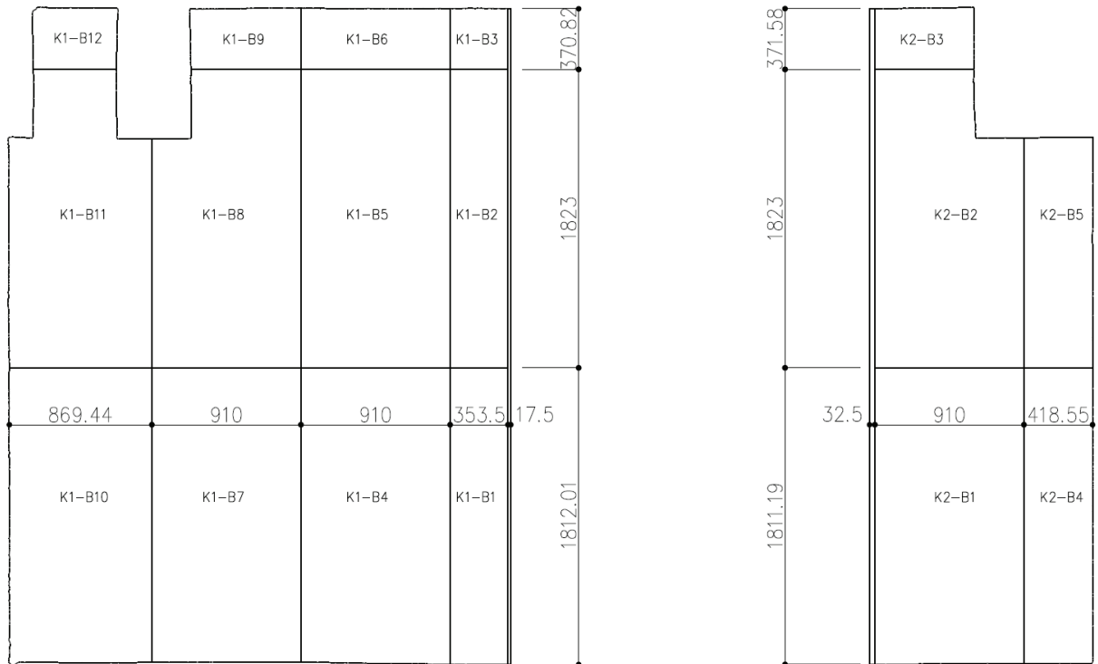
図 4.24 ポリゴンモデルに基づく割付図
