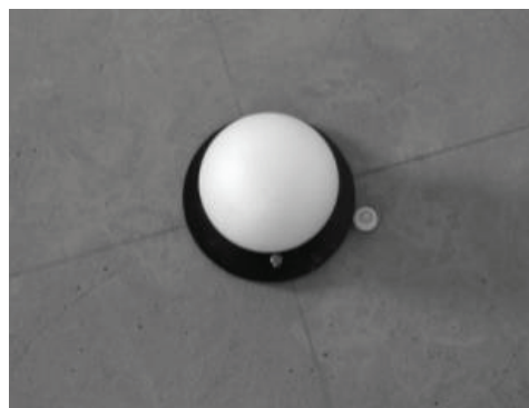
写真 2.2 通り芯に設置した球ターゲット
