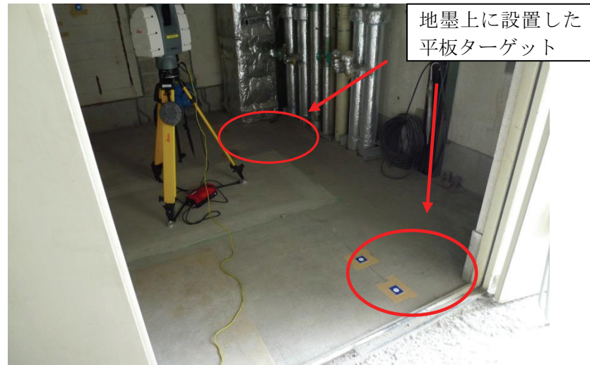
写真 2.5 地墨の位置を取得するために設置した平板ターゲット
