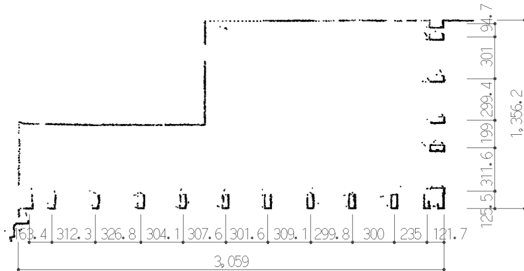
図 4.54 スタッドの出来形の断面とスタッドの断面寸法
