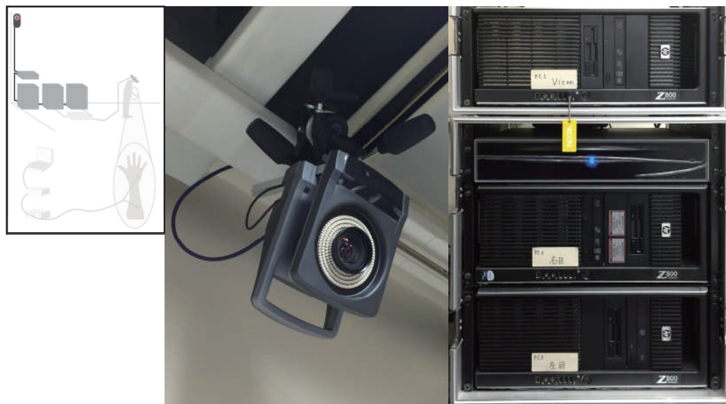
図 4-2 (左図) 光学反射式モーシオンキャプチャカメラ (右図上一段目) 制御 PC (右図上二段目) 光学反射式モーシオンキャプチャハードウェア (右図上三段目) 右目用処理 PC (右図上四段目) 左目用処理 PC
