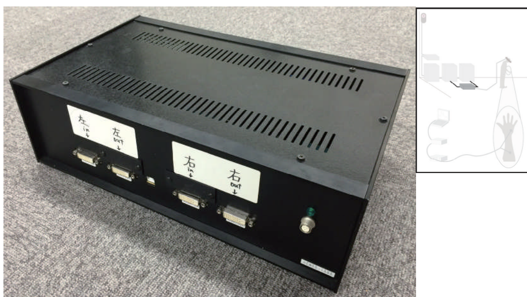
図 4-4 画像処理と HMD へ電源を供給する装置
