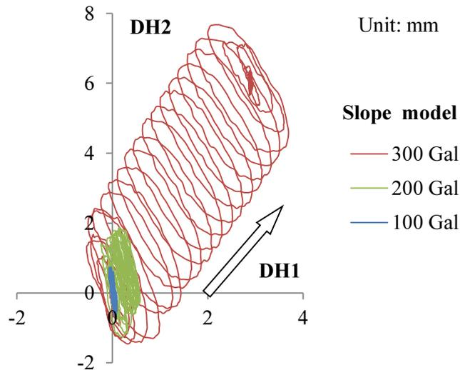
**Fig.3.28** Comparison of displacement between DH2 of superstructure and DH1 of pile cap in the slope model
