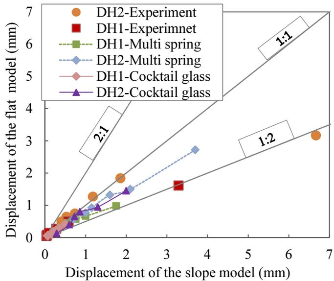
**Fig.5.30** Comparison of maximum horizontal displacement at DH1 and DH2 between the flat and slope models.
