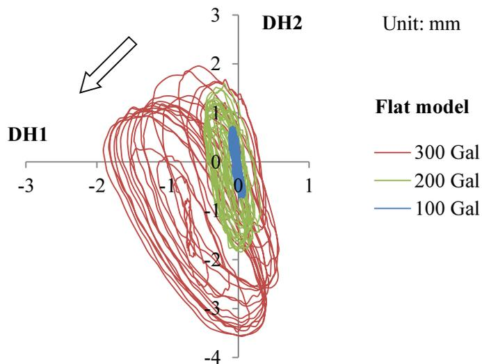
**Fig.3.26** Comparison of displacement between DH2 of superstructure and DH1 of pile cap in the flat model
