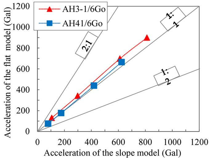
**Fig.4.9** Comparison of horizontal acceleration in case of  $1/6G_0$  at DH1 and DH2
