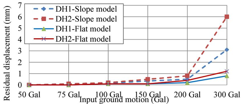
**Fig.3.30** Residual displacement at DH1 and DH2 in the flat and slope models
