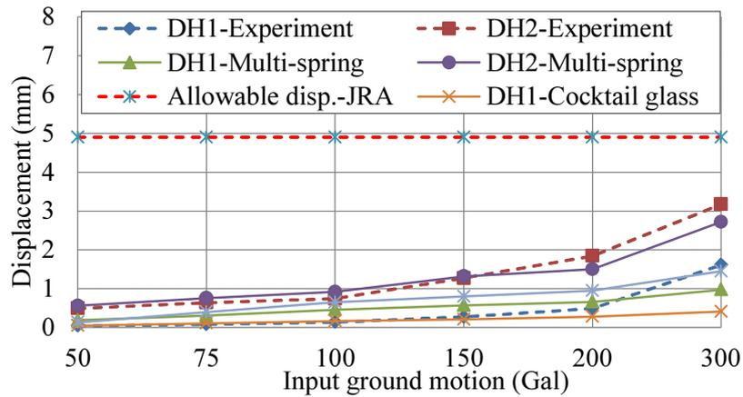
**Fig.5.26** Maximum horizontal displacement of the superstructure DH2 and pile cap DH1 in the flat model from 50 to 300 Gal
