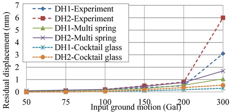
**Fig.5.29** Residual horizontal displacement of the superstructure DH2 and pile cap DH1 in the slope model from 50 to 300 Gal
