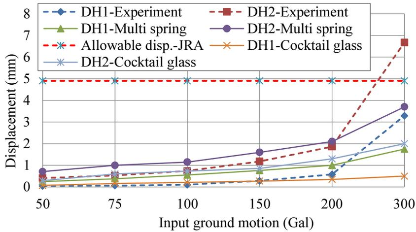
**Fig.5.28** Maximum horizontal displacement of the superstructure DH2 and pile cap DH1 in slope model from 50 to 300 Gal.
