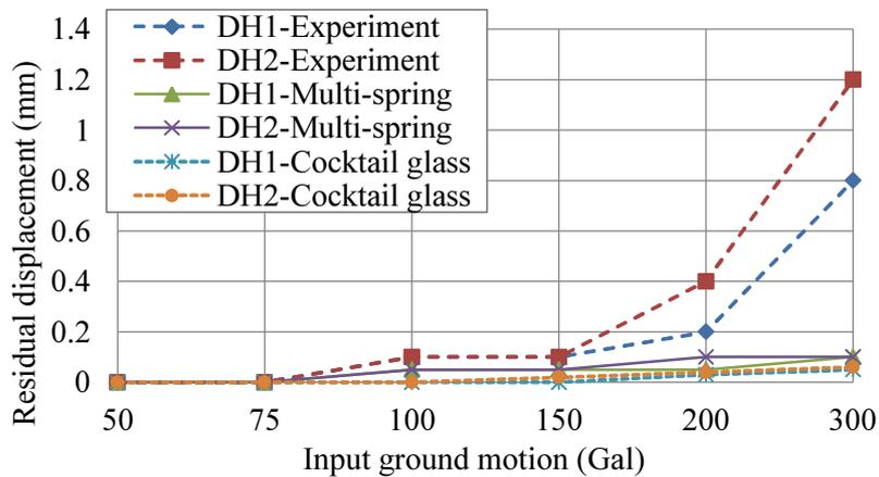
**Fig.5.27** Residual horizontal displacement of the superstructure DH2 and pile cap DH1 in the flat model from 50 to 300 Gal.
