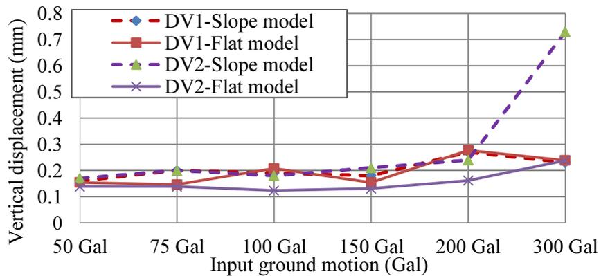
**Fig.3.31** Vertical displacement at DH1 and DH2 in the flat and slope models
