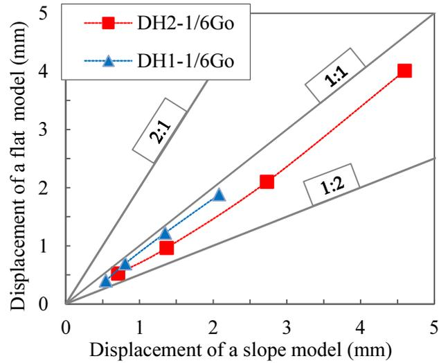
**Fig.4.8** Comparison of horizontal displacement in case of  $1/6G_0$  at DH1 and DH2
