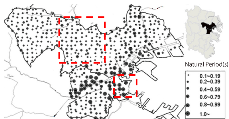
図3-16 微動の水平／上下スペクトル比から推定された軟弱地盤の卓越周期分布（文献 58) に加筆）
