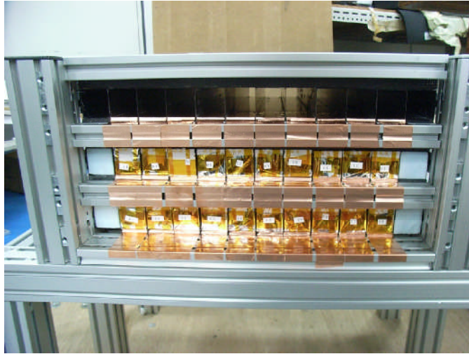
図 4.8: TASC 制作過程。CFRP 構造体の下 2 段に BGO を挿入した状態。周囲はアルミフレームで補強している。
