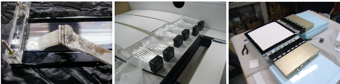
図 4.6: SciFi ベルト製作過程。(左) 白色塗料塗布、(中央) PMT との結合面研磨、(右) PMT および FEC との接合
