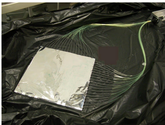
図 4.10: IMC 下部に配置したトリガー用プラスチックシンチレータ (S2)。格子状に埋め込んだ波長変換ファイバーを 1 束に束ねて PMT 感面まで導いている。
