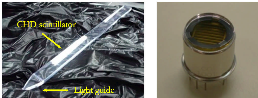
図 3.5: CHD 用プラスチックシンチレータ+ライトガイド (左) と PMT (右)。
