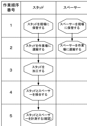
図. 4. 3. 10 「行為」のみを用いた計画方法による鋼製壁下地の作業プロセス(一部抜粋)
