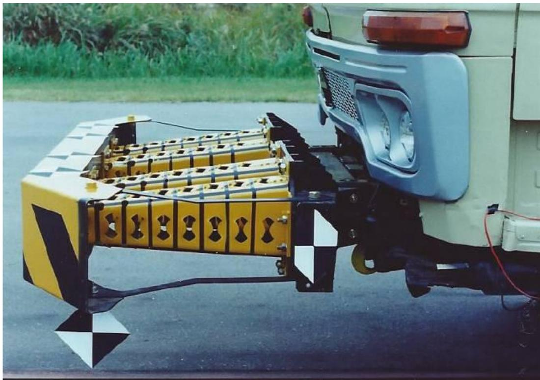
図 8.9 フロントエネルギー吸収システム
