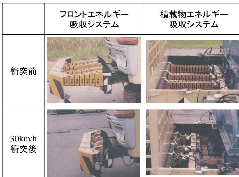
図 8.12 フロントエネルギー吸収システムおよび積載物エネルギー吸収システムの変形状況
