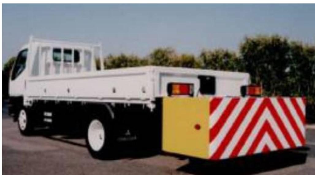
図 A1.5 エネルギー吸収システム式の追突衝撃緩和装置
