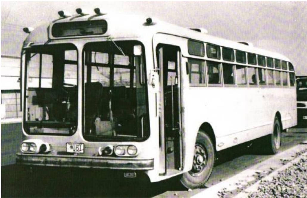
図 2.23 試験車① (三菱ふそう高速バス MAR820 形改造車)
