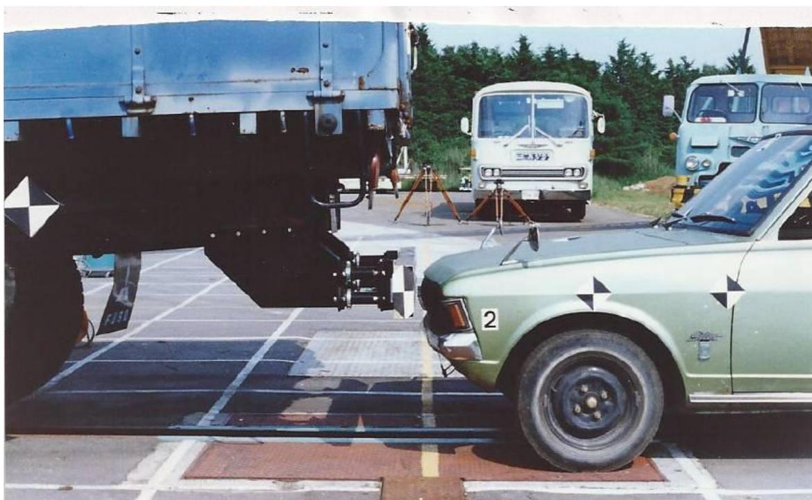
図 7.18 NFST に装着したエネルギー吸収リヤバンパ
