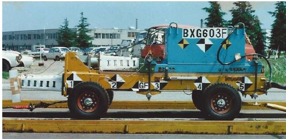
図 5.13 動負荷試験用台車
