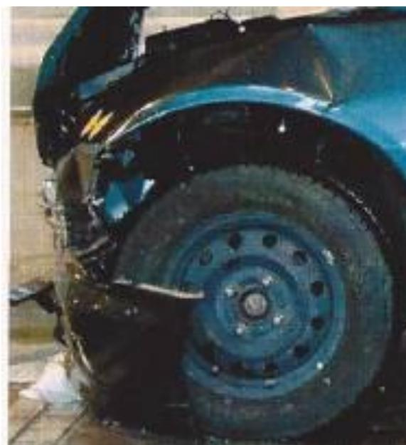
(b) 車両総重量 1.3t クラスセダン型乗用車の車体側面の変形状況
