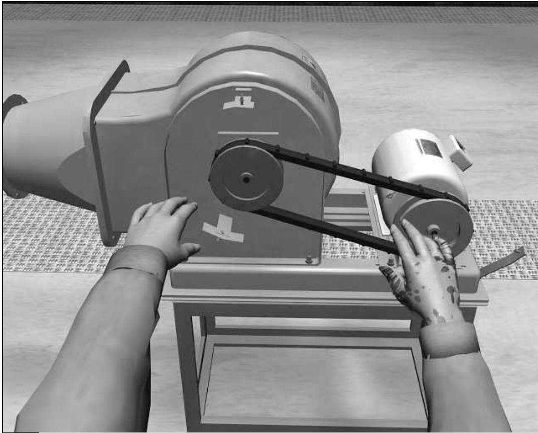
図5-8 送風機メンテナンス時の事故事例
