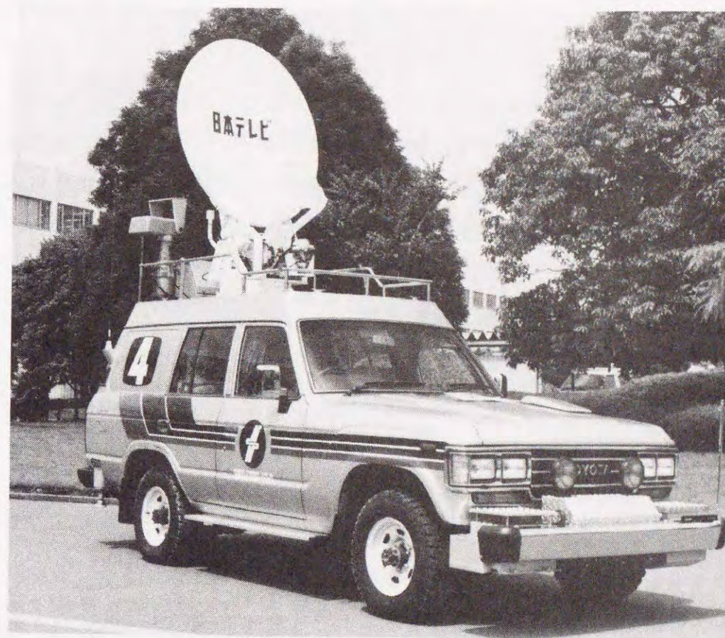
図4-5.11 S N G小型車載局 (アンテナは可倒式で走行時には格納される。)
