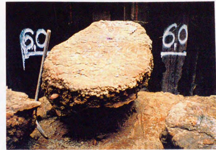
写真-5.4.1 緩結性薬液による固結形状
