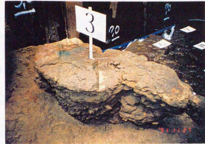
写真-5.4.7 瞬結性薬液のみ注入した場合の固結形状
