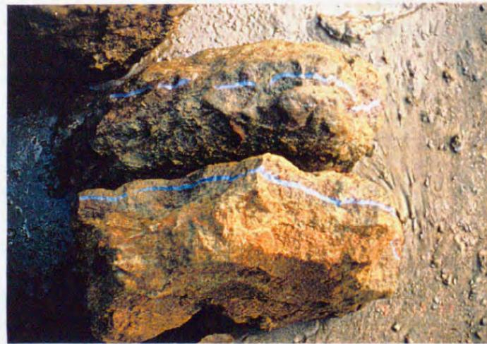
写真-5.4.5 緩結性薬液による割裂状況
