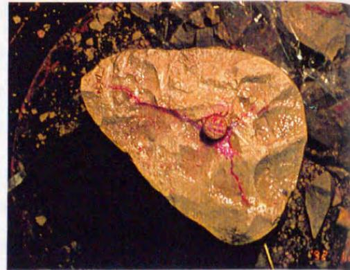
写真-4.2.4 供試体Dの固結形状
