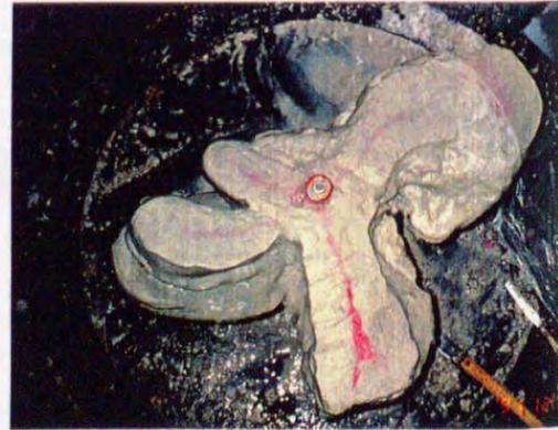
写真-4.2.6 供試体Dの固結形状
