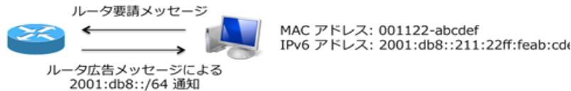
図 1. SLAAC による IPv6 アドレスの割り当て
