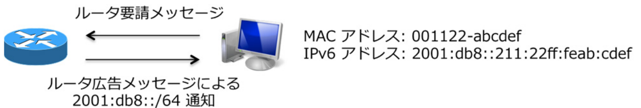
図 3.2: SLAAC による IPv6 アドレスの割り当て
