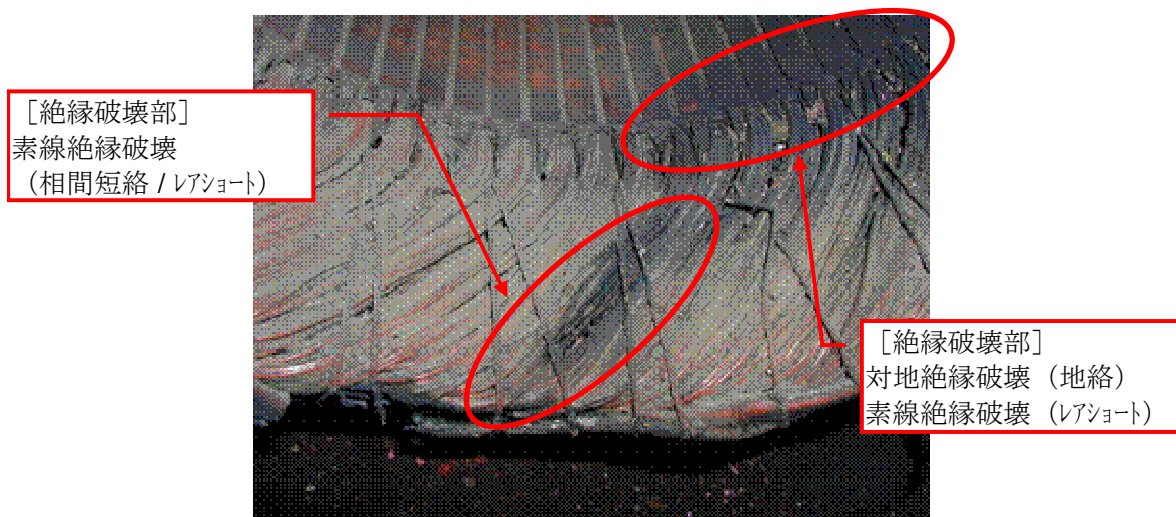
図3.4 (結線側) 固定子コイルエンド拡大
