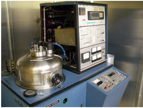
図 5-14 スパッタ装置 SPP430H とスパッタ後のウェハ
