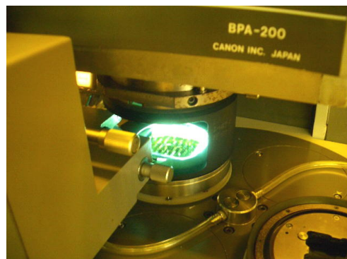
図 5-15 両面露光機 BPA-200 と露光時の様子
