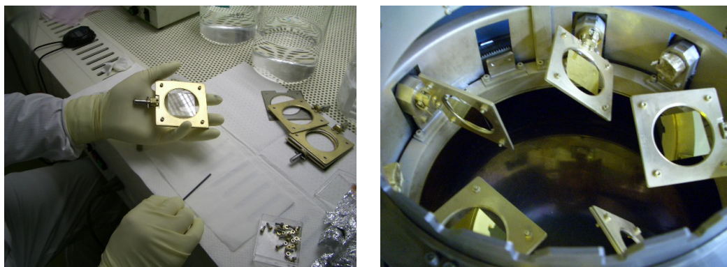
図 5-13 基板ホルダとスパッタ装置の自公転治具
