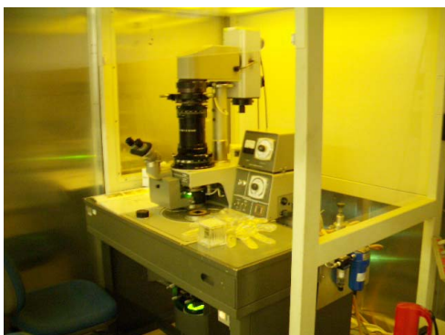
図 5-15 両面露光機 BPA-200 と露光時の様子
