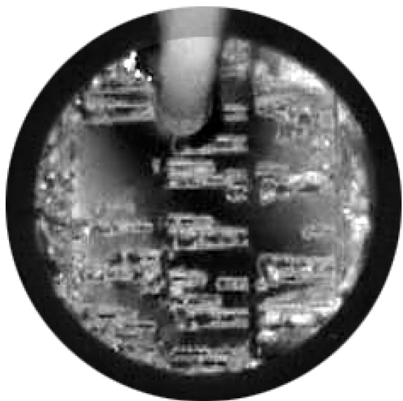
Fig. 4.14 シングルパルスによる周期分極反転 実時間観察像. 周辺の黒い部分は内径 8 mm \phi の O-ring である.
