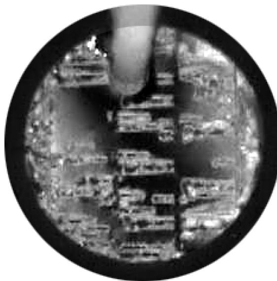
Fig. 4.13 金属電極を用いた周期分極反転実時間観察像. 周辺の黒い部分は内径 8 mm \phi の O-ring である.
