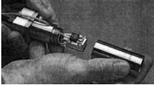
Fig. 1.9 受動 Q スイッチ型マイクロチップレーザ励起光パラメトリック発生モジュール [48]
