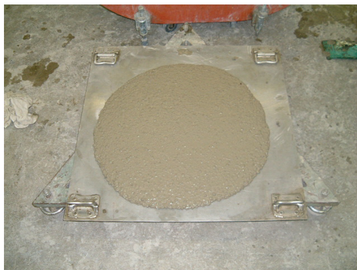
写真-4.5 スランプフロー試験の状況
