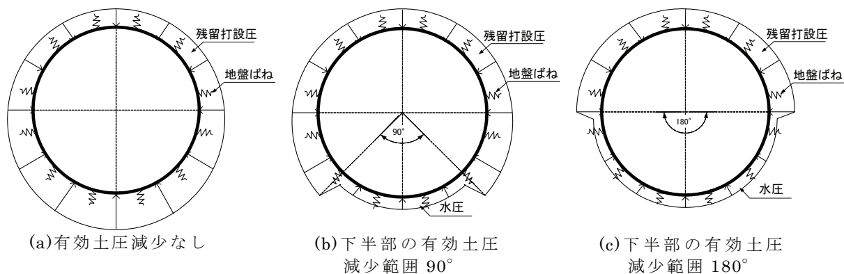
図-6.23 ライニングに作用する荷重の概念図
