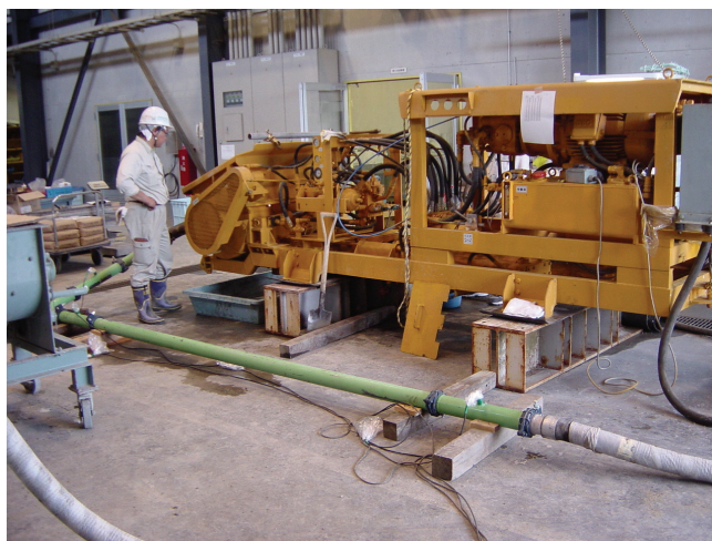
写真-4.7 ポンプ圧送試験の状況(1)
