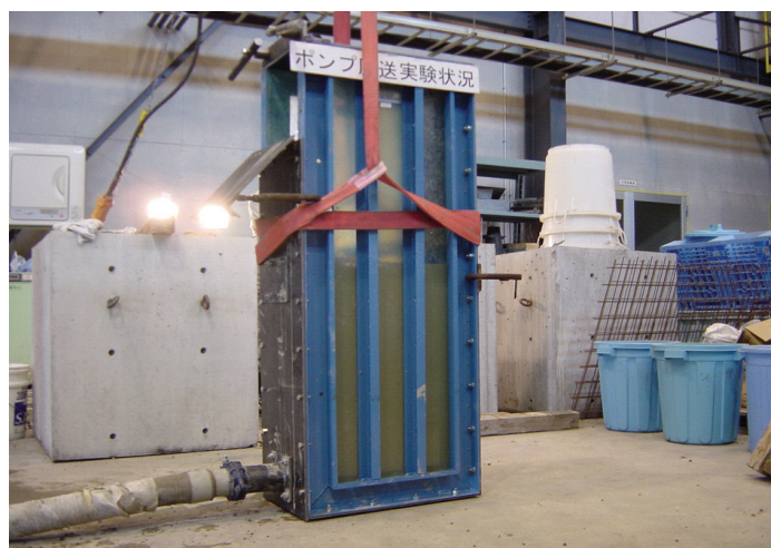
写真-4.8 ポンプ圧送試験の状況(2)
