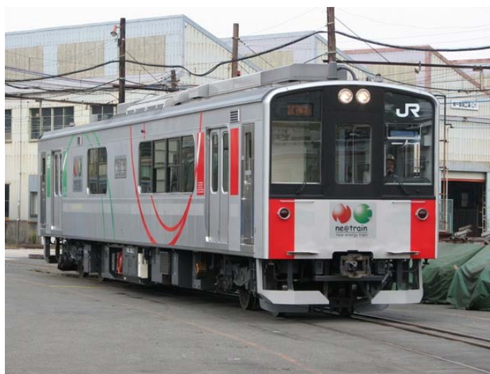
図1. 1. 4 JR東日本のバッテリー試験電車「NETレイン」
