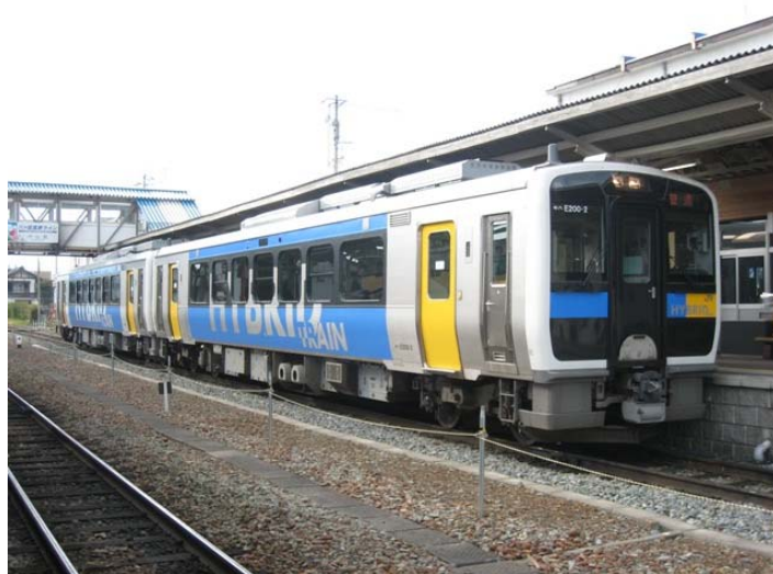
図1. 1. 5 JR東日本のディーゼルハイブリッド鉄道車両「キハE200形」
