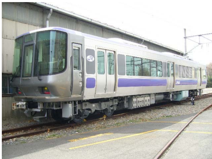
図1. 1. 3 鉄道総研の燃料電池試験車両
