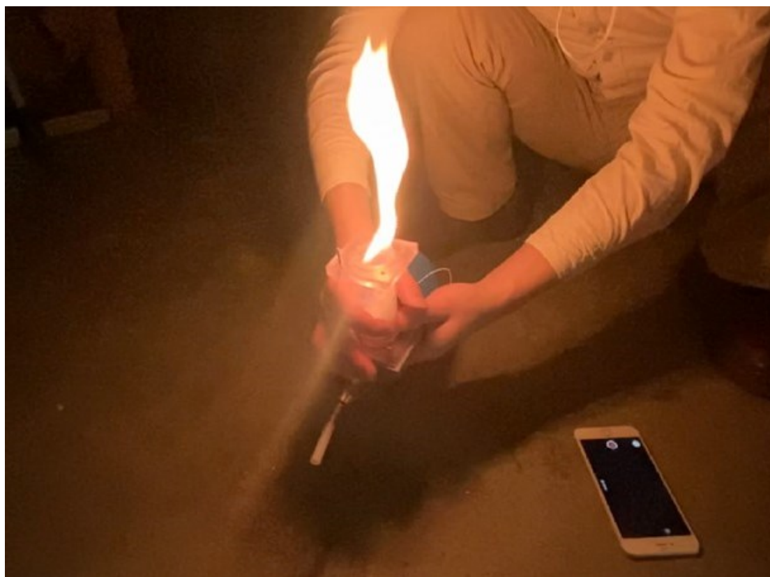
図 6-7 本研究で作製した粒子状の i-BH が燃焼する様子 学術研究だけでなく,教育や広報のための一般演示実験にも安全 に活用できる.
