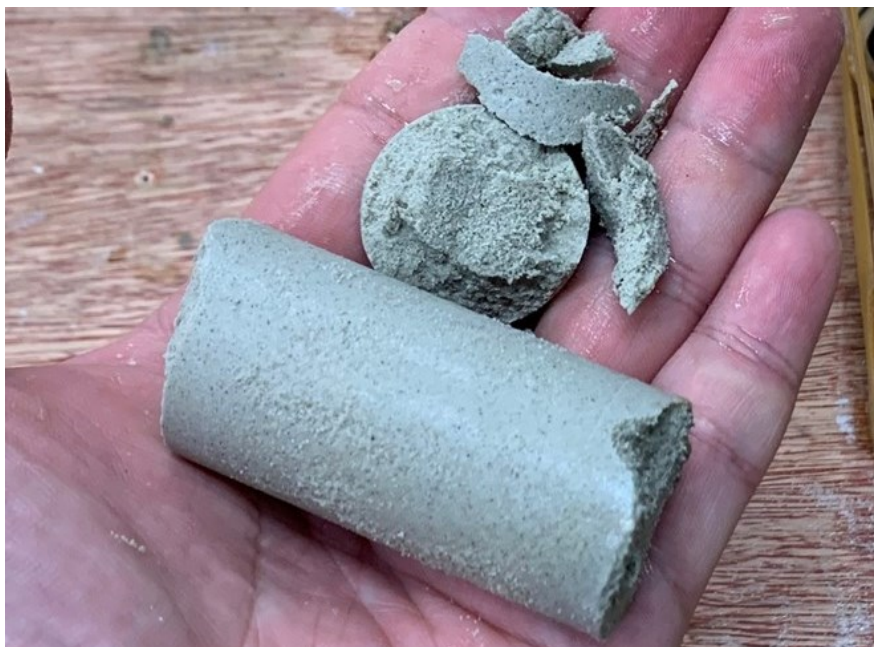
図 7-22 60日間養生後の供試体 B 組の一例 慎重に押し出したにもかかわらず破損が発生し、 改良剤の水和反応の進行が極めて遅いことが分かる。
