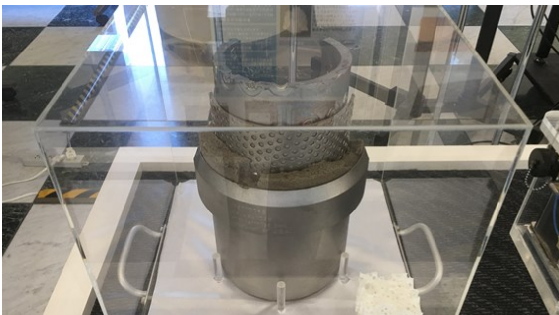
図 3-1 独立行政法人石油天然ガス・金属鉱物資源機構が保有する グラベルパック・スクリーン・GeoFORM™の実物切断モデル (劉による撮影)
