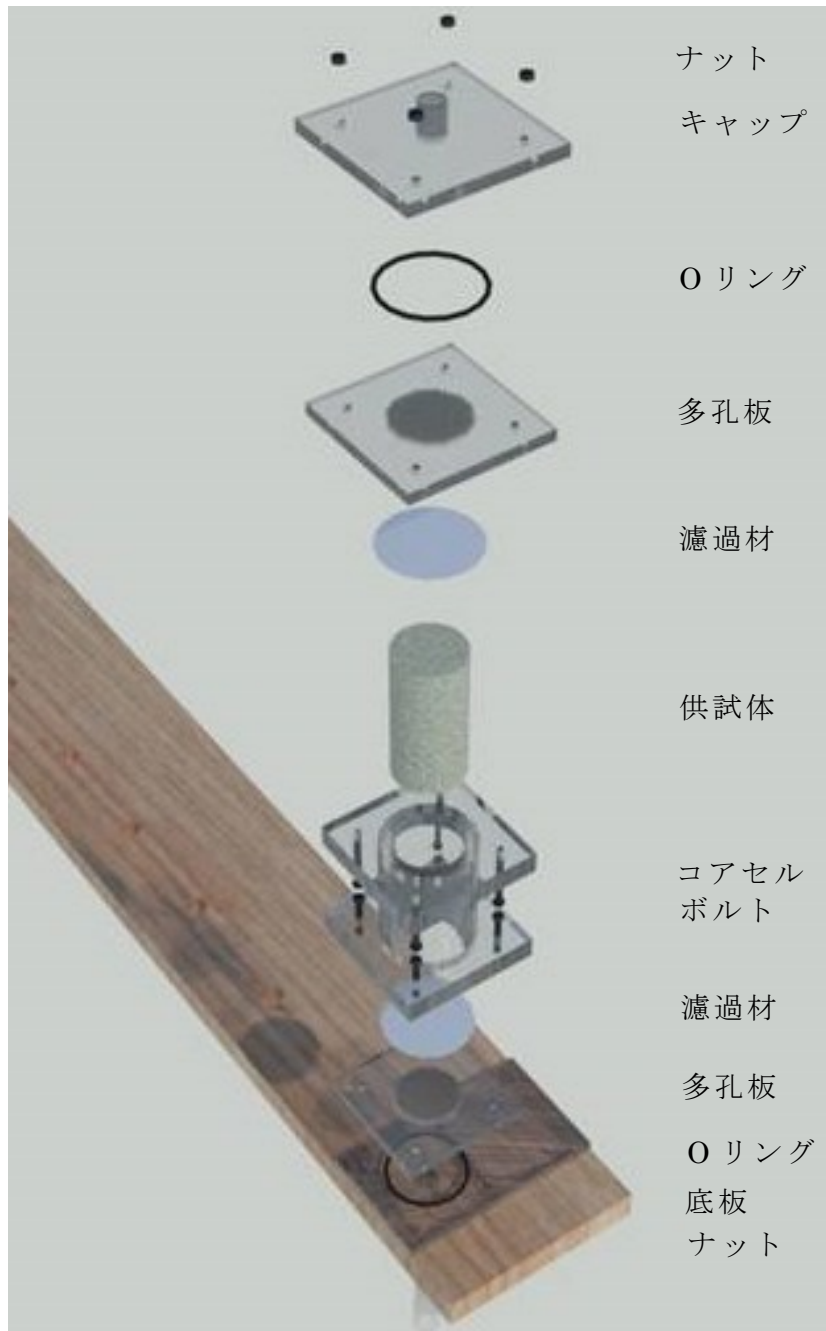
図 5-17 3号機のコアセルの組み立て CG 図（設計段階）
