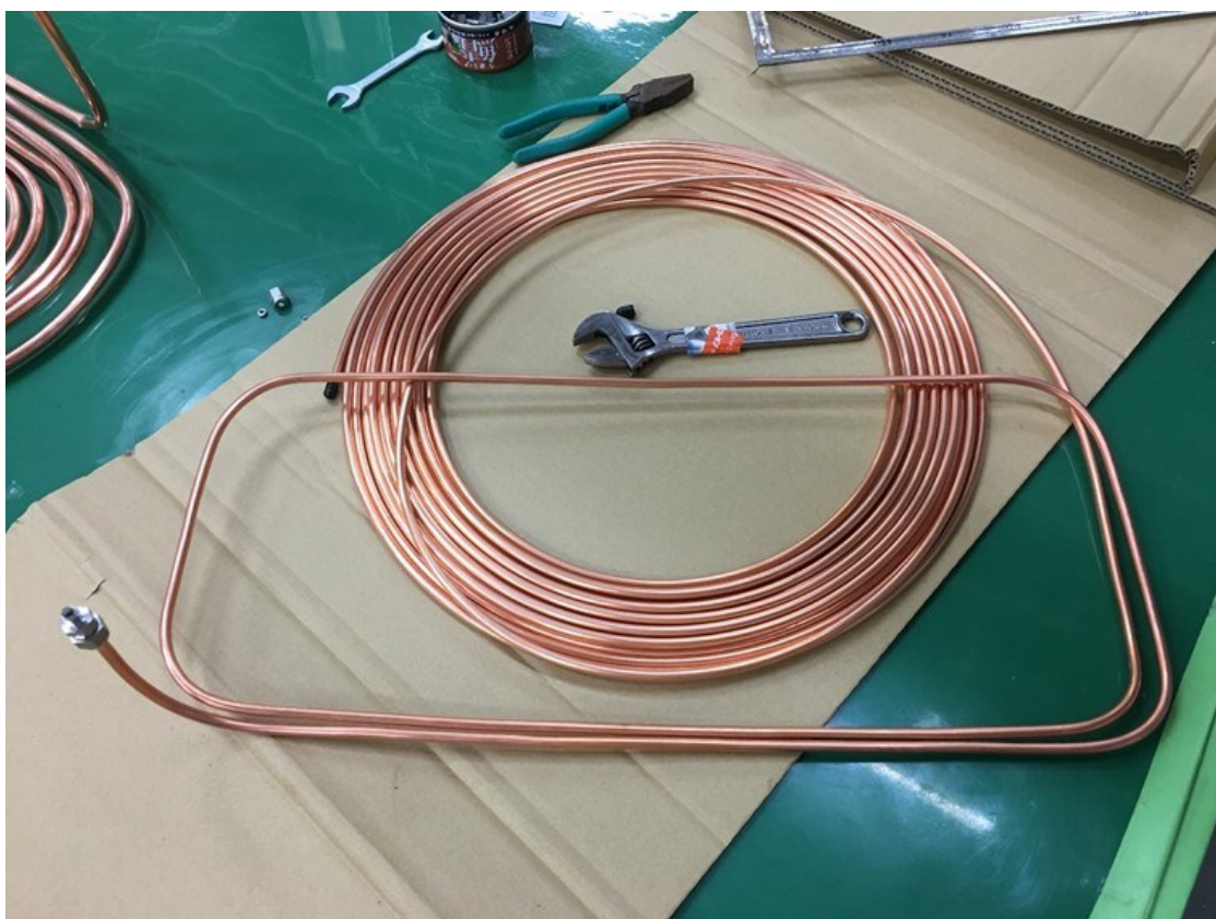
図 5-34 測定流体（空気）を冷却するための銅管（製作時）
