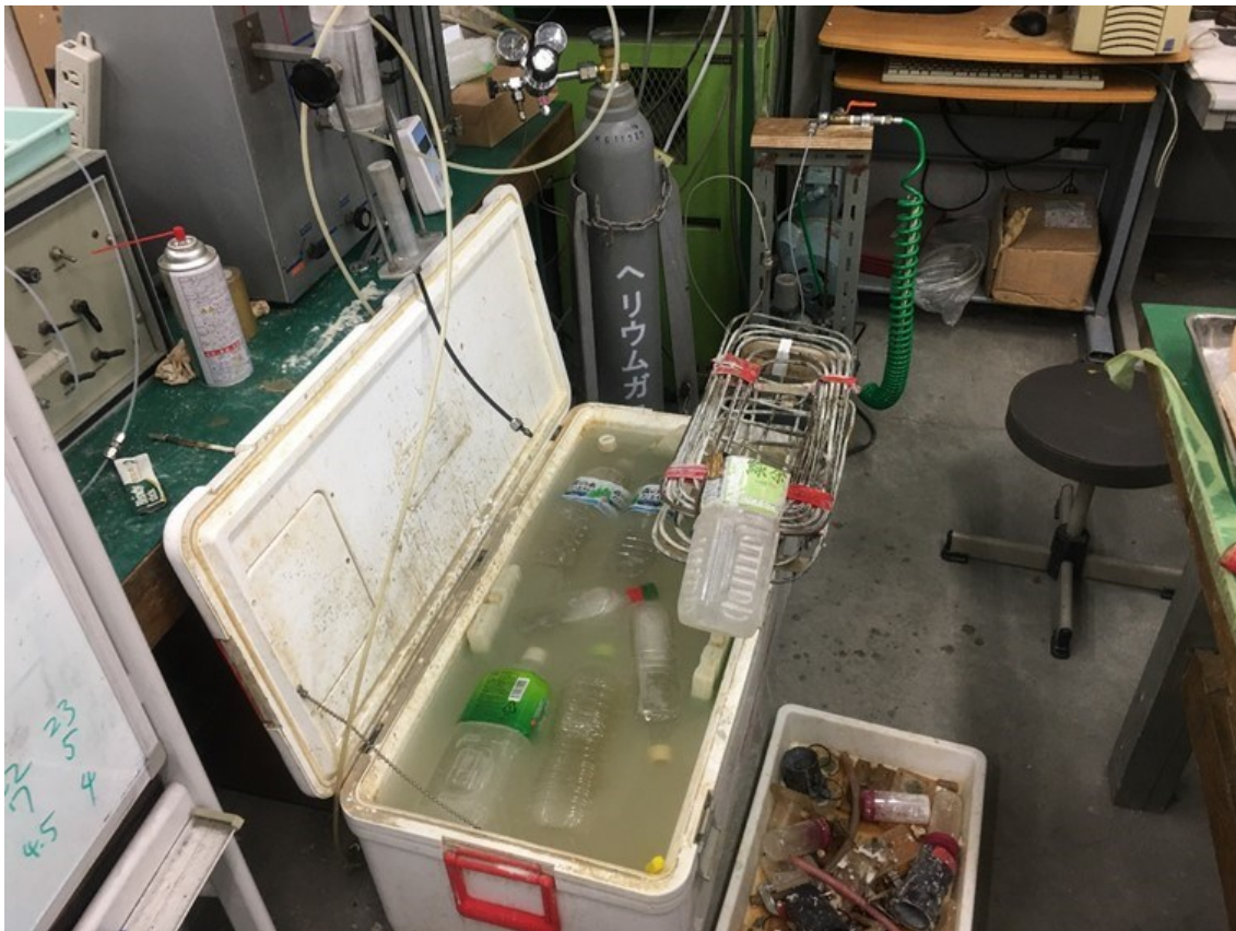
図 5-35 TH を含む供試体向けの浸透率測定装置
