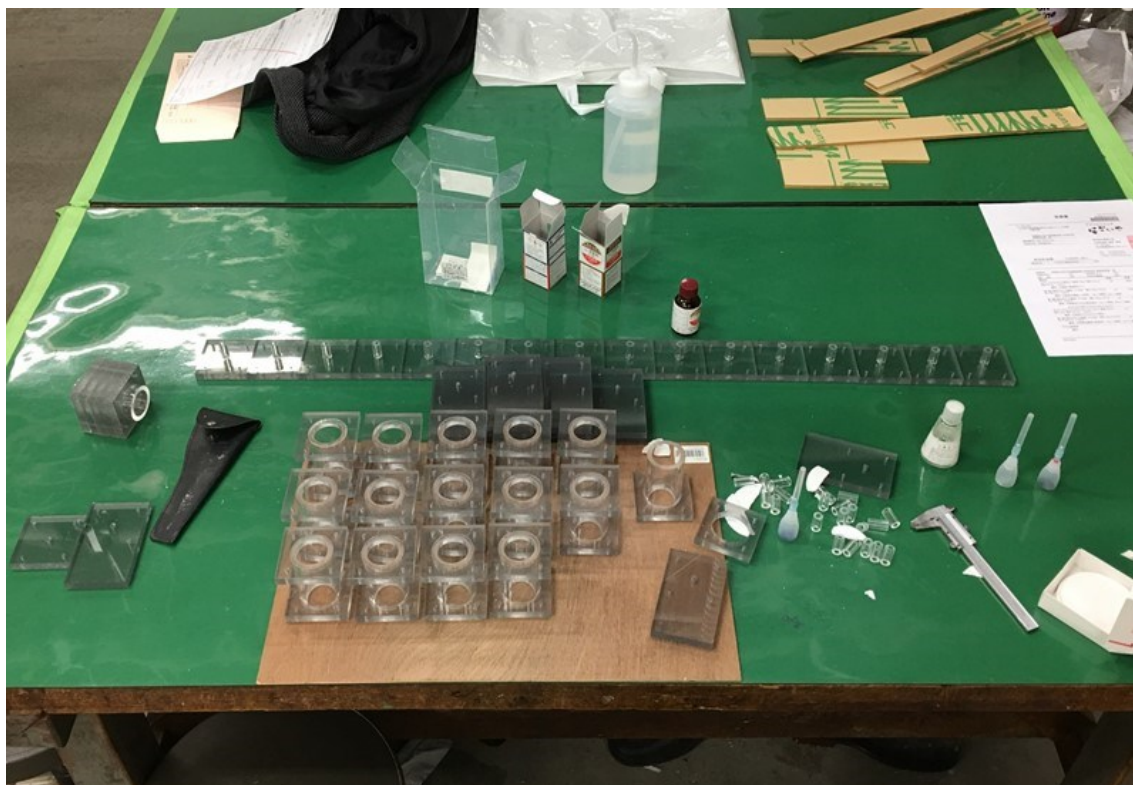
図 5-19 3号機のコアセル （耐薬品性を強化した後期型，製作段階）
