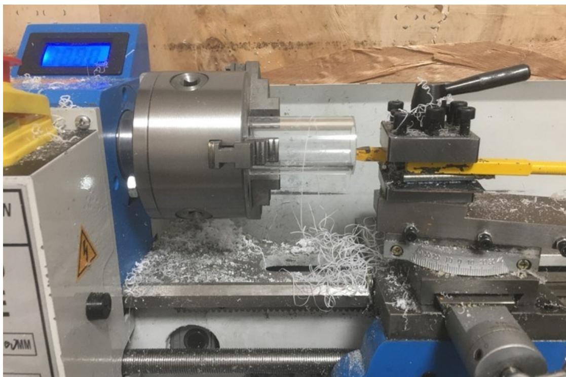
図 5-13 旋盤によるコアセル胴体の開口部の加工風景
