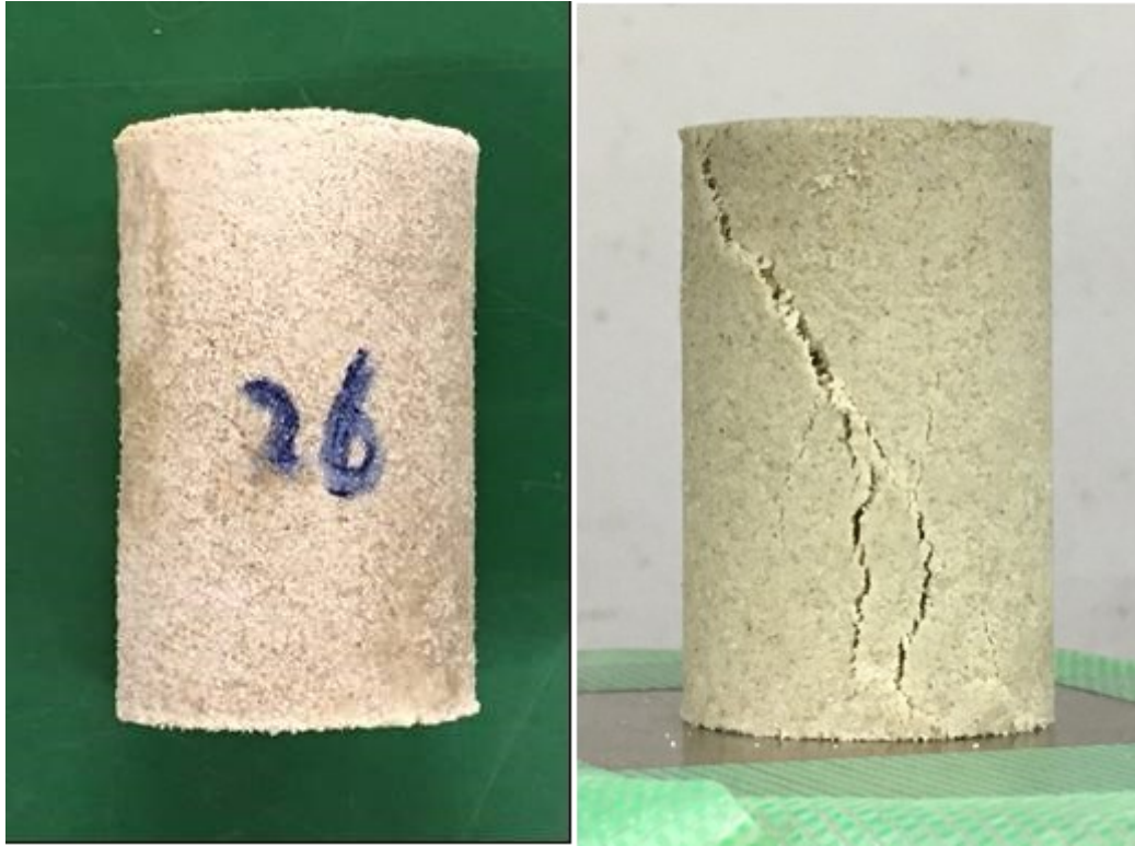
図 7-4 本手法による供試体の一例 ( S_{TH}=60\% )
