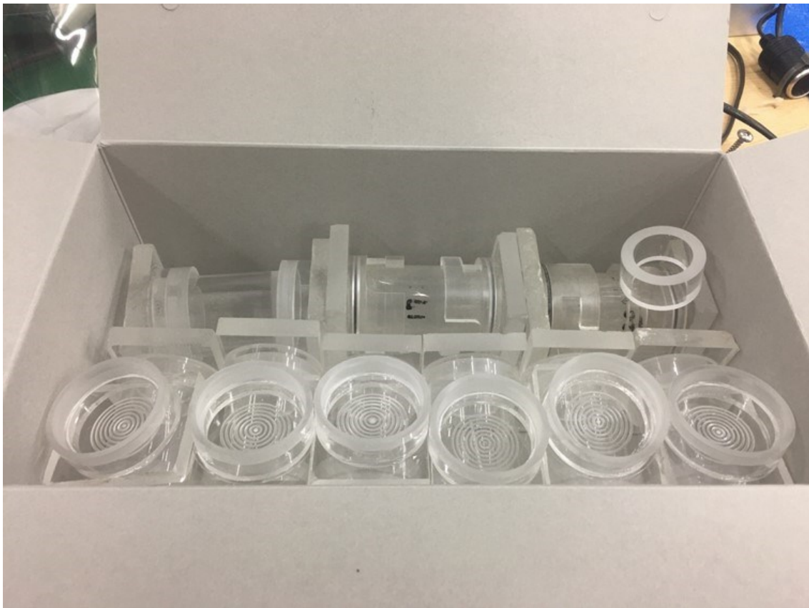
図 5-20 新 3 号機のコアセル（解体状態）
