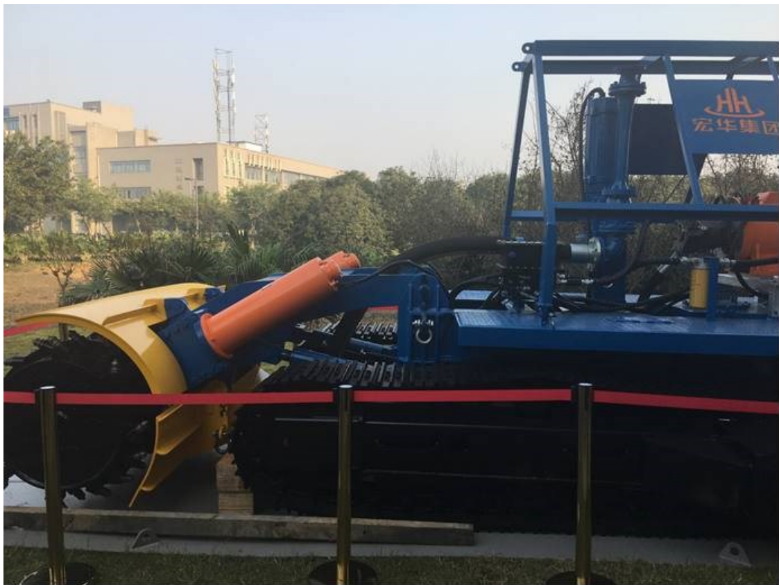
図 2-7 固形流化法に使用される遠隔操作の切削圧送機械 （海底コンバイン）
