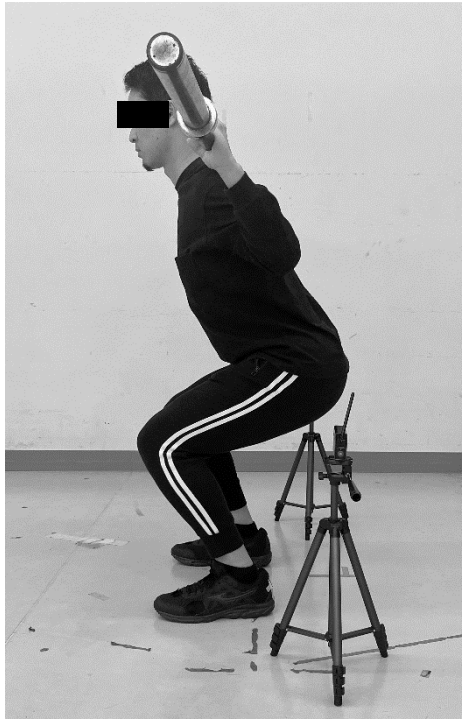
図 6-1: 光電管を用いた反動動作の深度の規定
