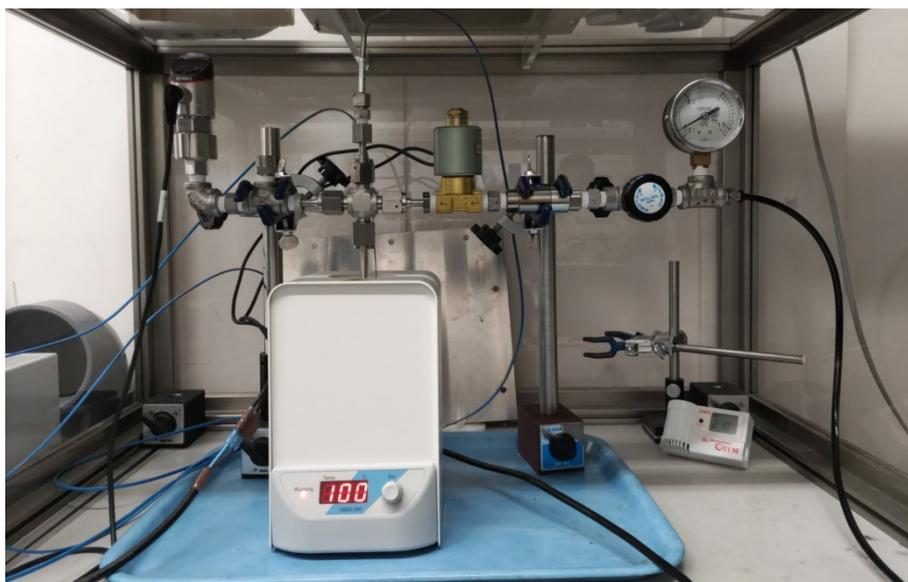
図 74 電磁弁設置後の定容器型反応装置
