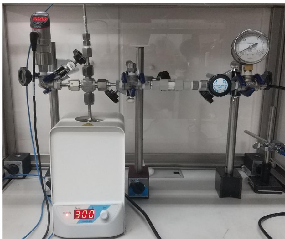
図 52 製作した定容器型反応装置 [55]
