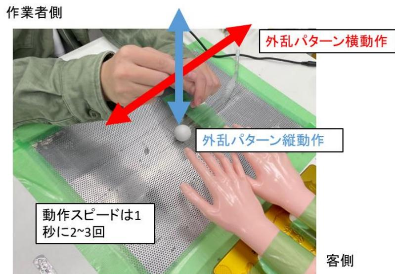
図 5.2 作業者の手の作動方向
