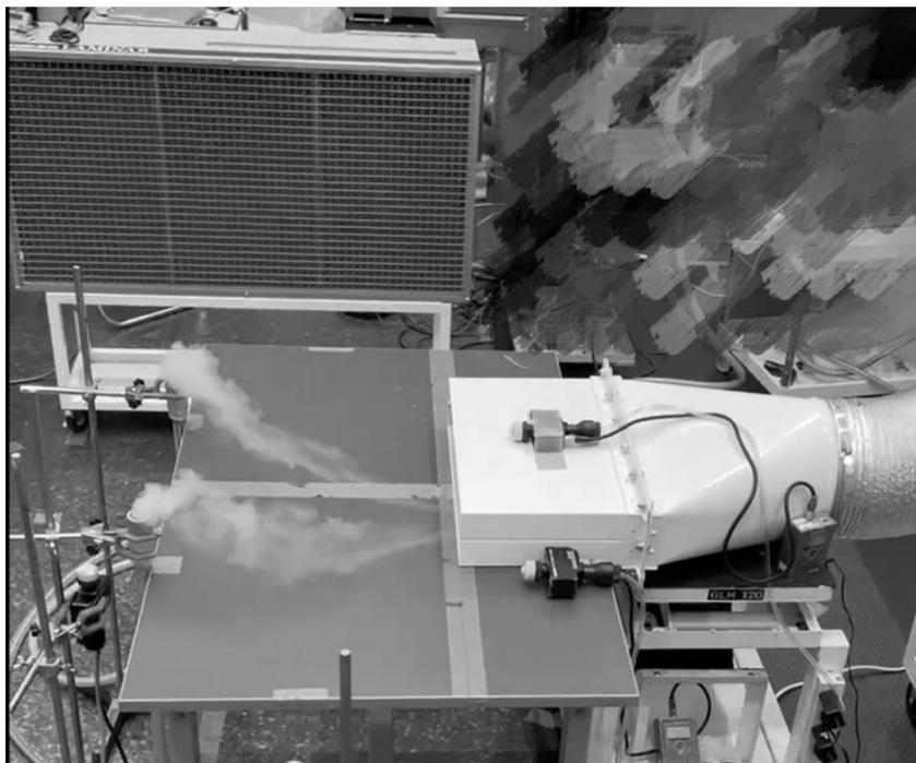
図 2.5 実験による横風外乱気流が発生した場合の煙の様子
