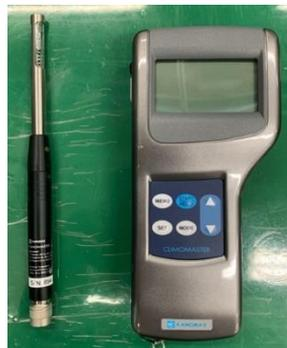
図 4.4 クリモマスター風速計の外観
