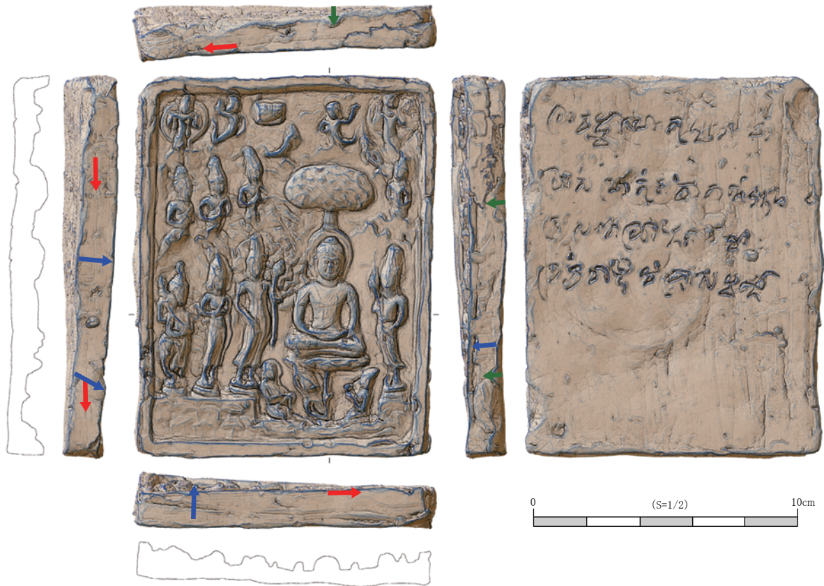
図6：會津八一記念博物館所蔵埴仏の三次元計測と製作技法
