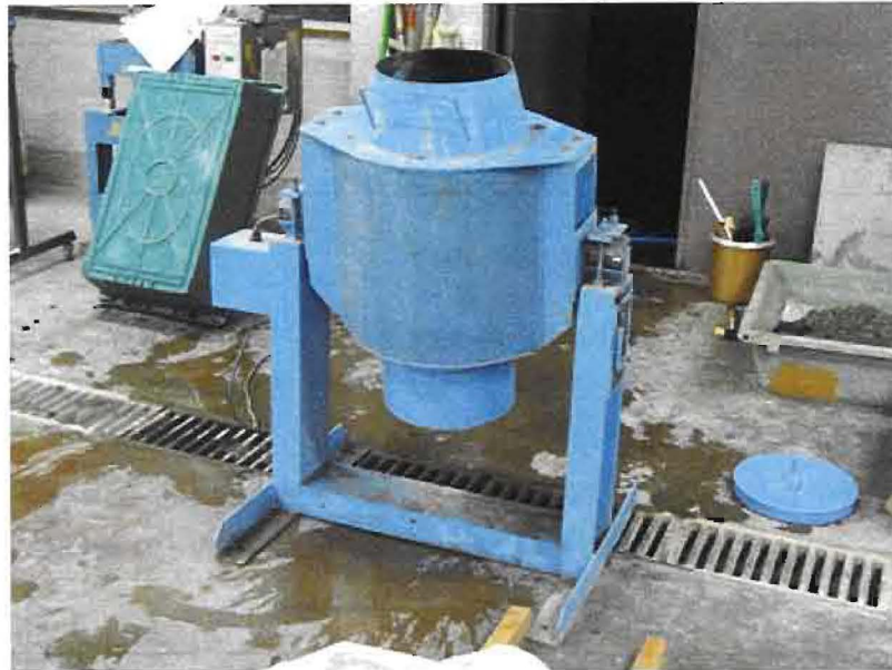
写真 3.2-1 オムニミキサ（千代田技研工業社製 OM-10）
