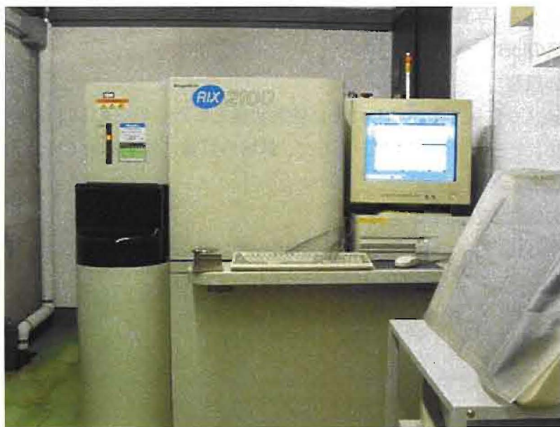
写真 2.2-3 蛍光 X 線分析装置（理学電機工業社製 RIX2100）
