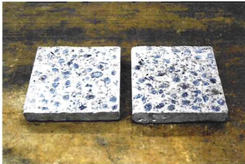
写真 3.2-3 骨材現し型コンクリート（凝結遅延剤シート使用）
