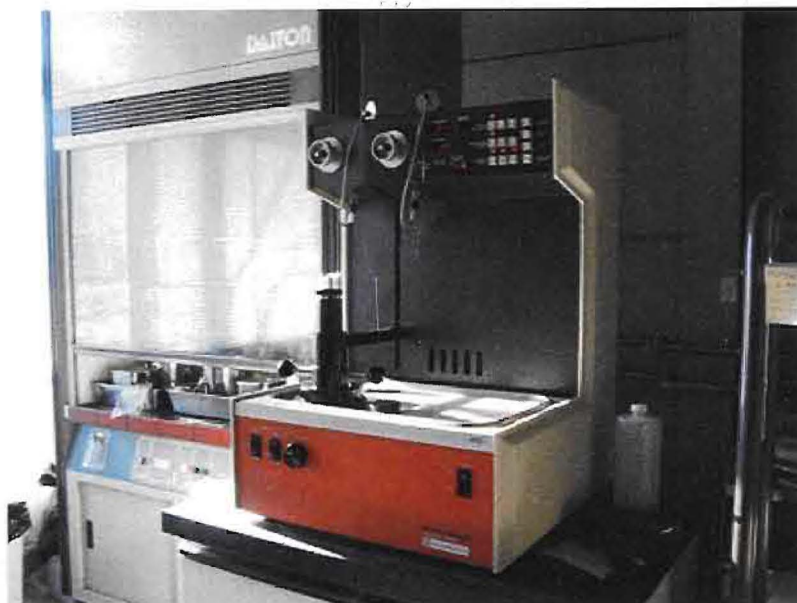
写真 2.2-6 水銀圧入式ポロシメータ (Micromeritics 社製 PoreSizer 9320)
