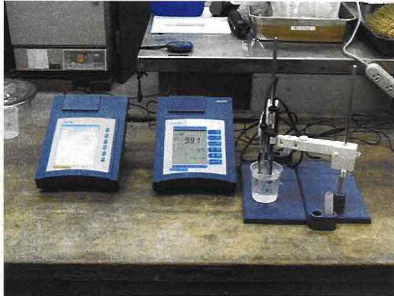
写真 2.2-5 ガラス電極式 pH 計（東亜ディーケー社製 HM-25G）
