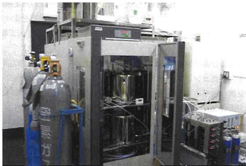
写真 3.2-5 低減量性能試験装置
