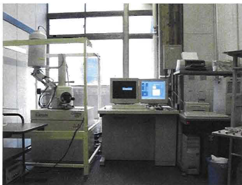
写真 2.2-8 走査型電子顕微鏡（日立ハイテクノロジー社製 S-3000N）
