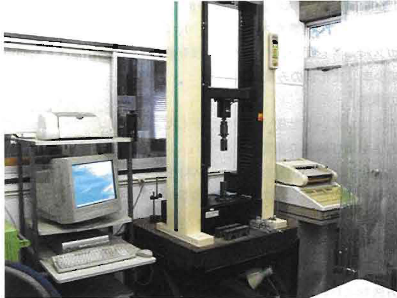
写真 2.2-7 高精度定速ひずみ方式万能試験機（島津製作所社製 AG10kN-E）
