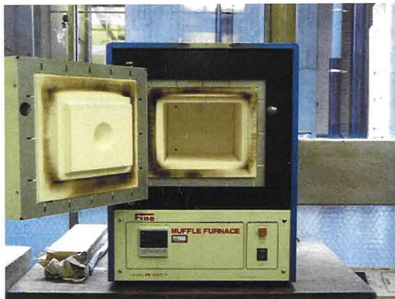
写真 2.2-2 電気炉（東京硝子器機社製 FN-215-S）
