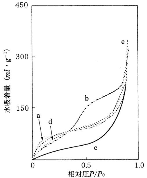
図10 Ti-ベータゼオライトへの $H_2O$ 吸着等温線と $H_2O$ 吸着量に対する前処理の効果
