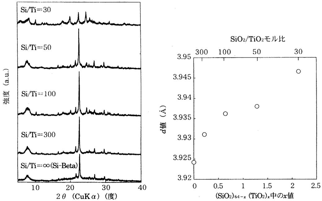
図9 DGC法によるTi-Si-ベータゼオライトの合成
