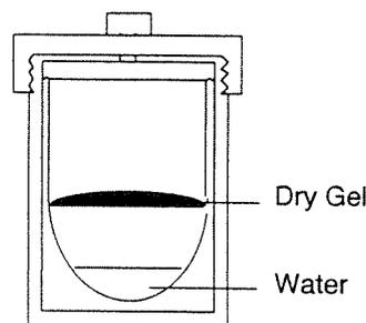
図1 ドライゲルコンバージョン法に用いるオートクレーブ
