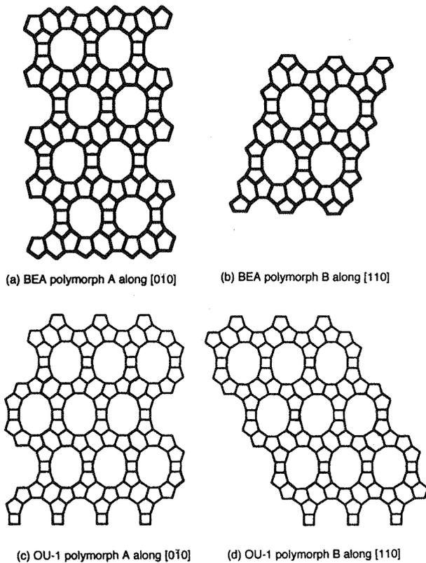
図5 BEAおよびOU-1の骨格構造
