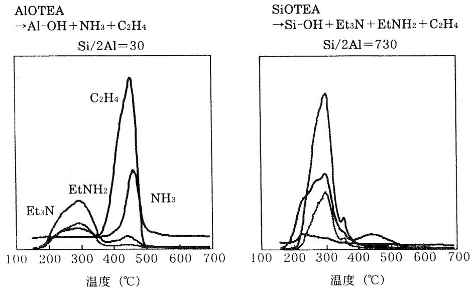
図5 ゼオライトベータ (SiO<sub>2</sub>/Al<sub>2</sub>O<sub>3</sub>=30, 730) に取り込まれたTEAカチオンの昇温分解スペクトル
