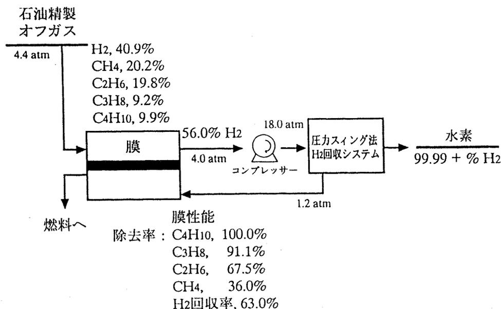
図4 SSF™膜を用いた石油精製オフガスからの水素回収プロセス
