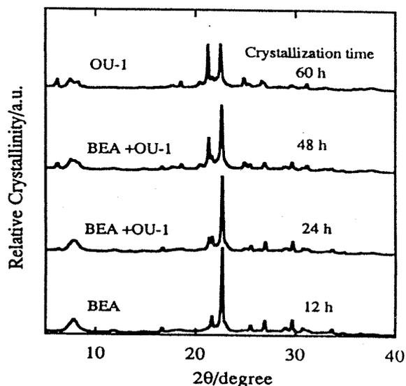
図5  $\text{SiO}_2/\text{Al}_2\text{O}_3$ 比=380の乾燥ゲルからのBEAの生成およびOU-1への相転移。結晶化温度、 $180^\circ\text{C}$ 。 $\text{SiO}_2/\text{Na}_2\text{O}$ 比=23.8。
