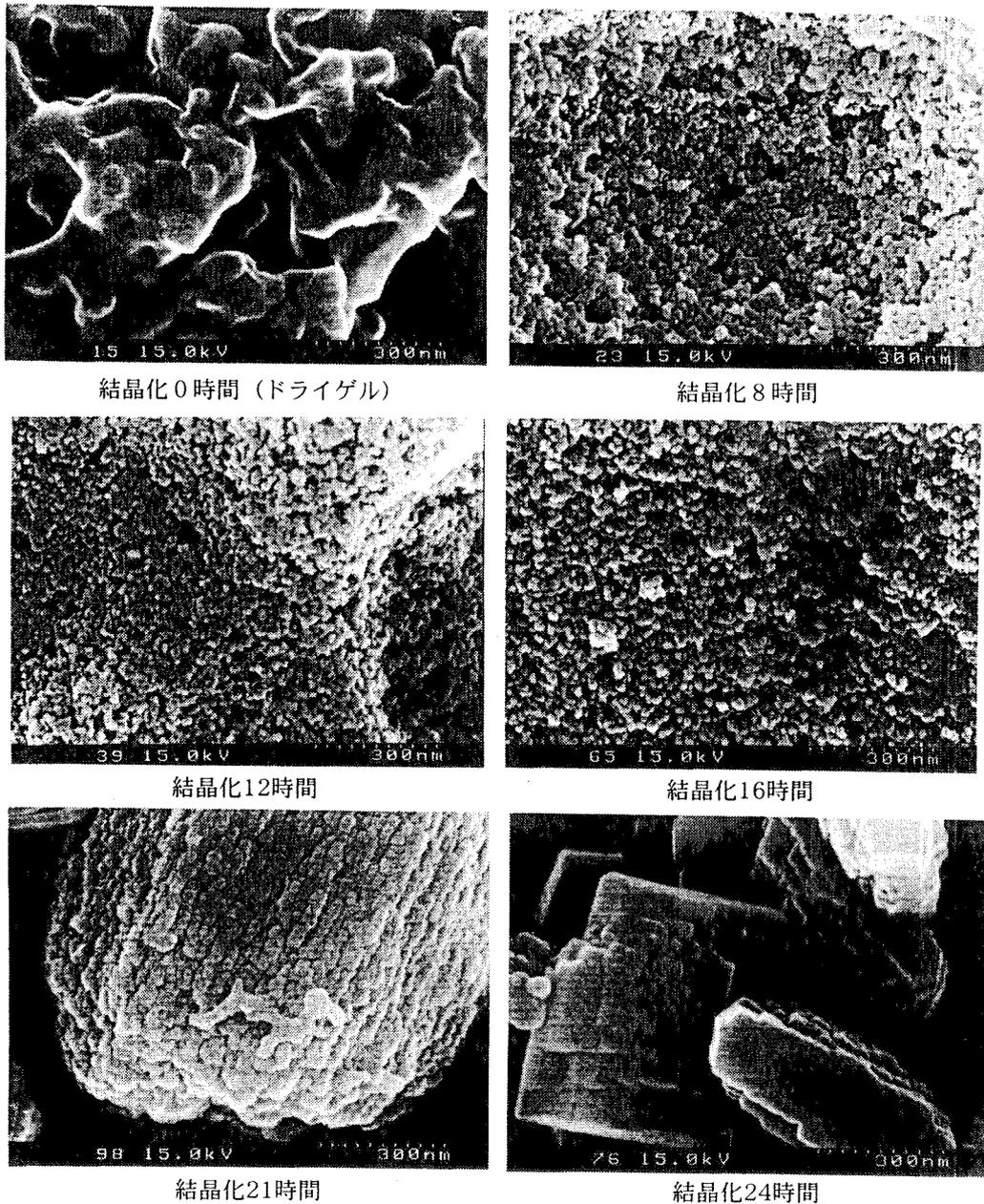
図6 ゼオライトベータ ( $\text{SiO}_2/\text{Al}_2\text{O}_3=730$ ) 結晶化過程におけるモルフォロジー変化
