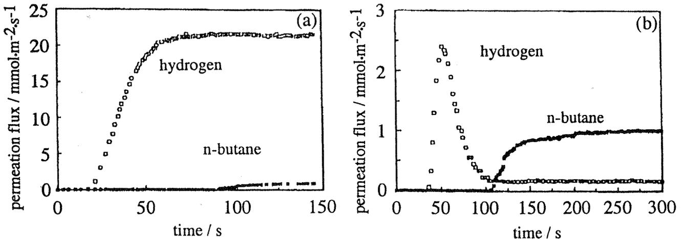
図 1 水素(95kPa), *n*-ブタン(5 kPa)の 27°Cにおける透過流速の経時変化. (a)単成分系, (b)混合系, シリカライト
