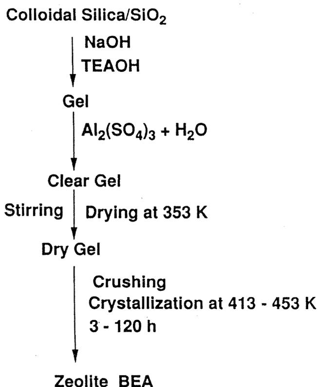
図3 ドライゲルコンバージョン法によるBEAの合成レシピ
