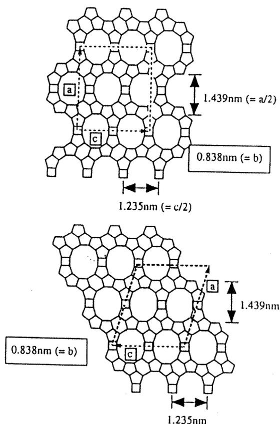
図7 電子線回析より推定されるOU-1の構造。主としてこの2種類のpolymorphより構成されていると考えられる。
