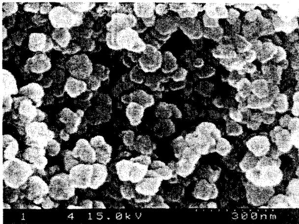
図3 DGC法で合成したゼオライトベータ ( $\text{SiO}_2/\text{Al}_2\text{O}_3=100$ ) のSEM像
