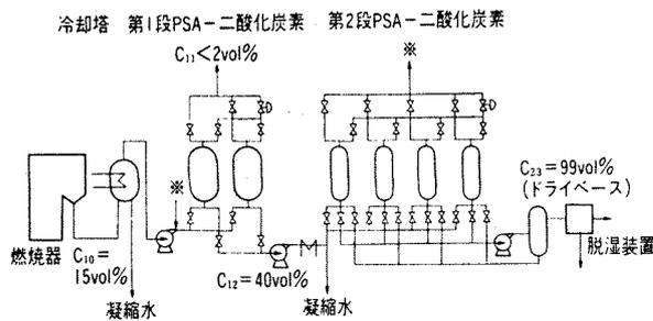
図1 PSA-二酸化炭素フローシート
