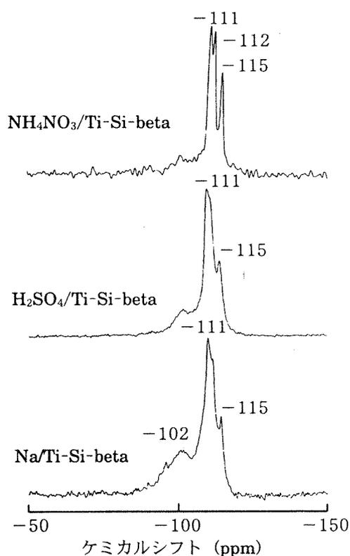
図11 Ti-Si-ベータゼオライトの<sup>29</sup>Si-MASNMRスペクトル
