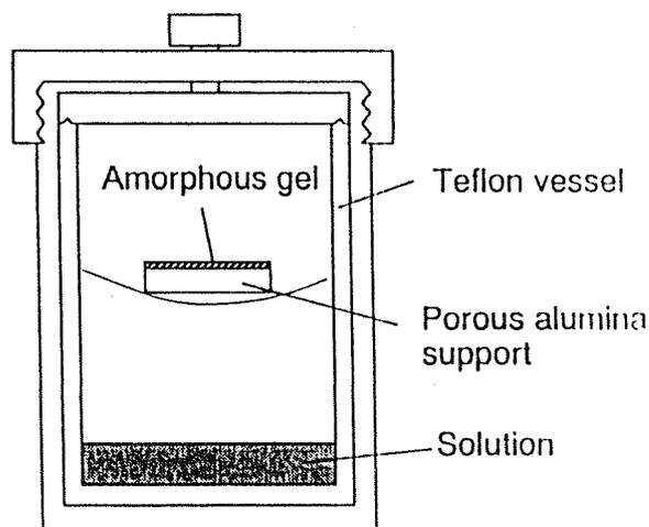
図1 ドライゲルコンバージョンに用いるオートクレーブ
