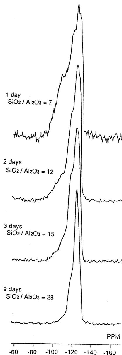
図2 気相輸送法によって合成したZSM-5の<sup>29</sup>Si-NMRスペクトル
