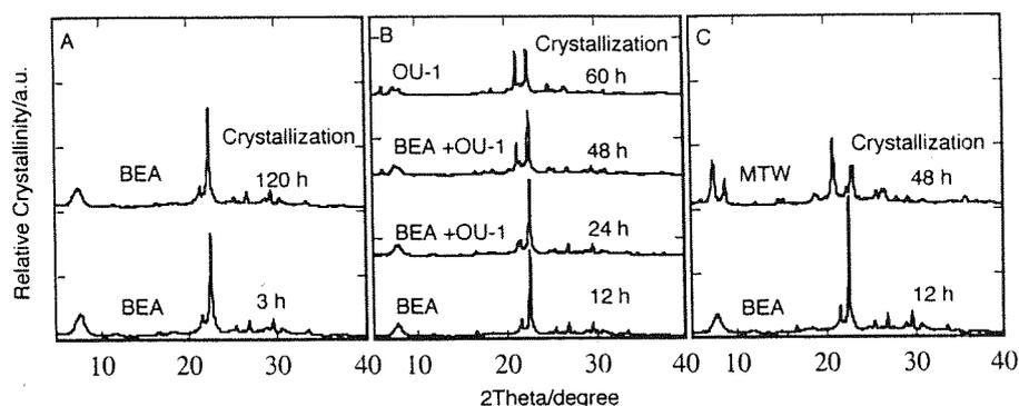
図2 BEAおよび相転移により生成したOU-1(B), MTW(C)のXRDパターン
