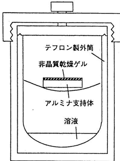
図2 気相輸送法によるゼオライト膜合成用オートクレーブ
