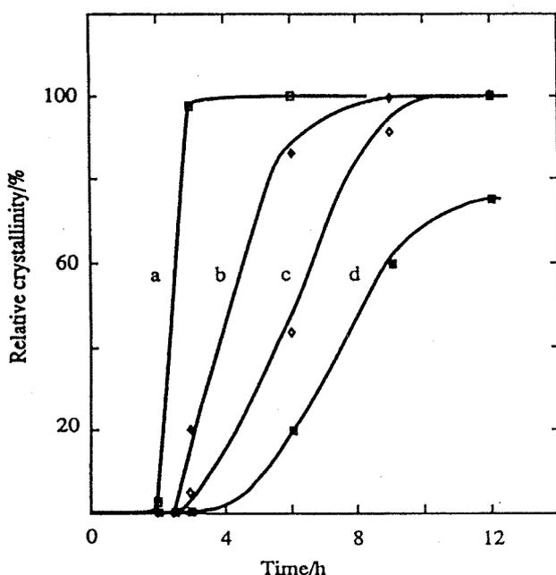
図4 BEAの結晶化曲線。原料組成 ( $\text{SiO}_2/\text{Al}_2\text{O}_3$ 比、 $\text{SiO}_2/\text{Na}_2\text{O}$ 比、 $\text{SiO}_2/\text{SO}_4^{2-}$ 比の順) : a, 30, 23.8, 20.9; b, 380, 23.8, 528; c, 730, 10.9, 10; d, 730, 23.8, 0。結晶化温度、 $180^\circ\text{C}$ 。 $\text{SiO}_2/\text{SO}_4^{2-}$ 比は硫酸を添加することにより調整。
