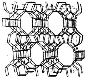
図3 ベータ (Polymorph A) の構造
