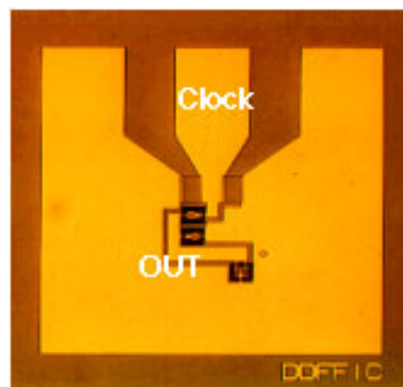
図 5.10: 試作した光電融合型フリップフロップ回路（負論理型）のチップ写真
