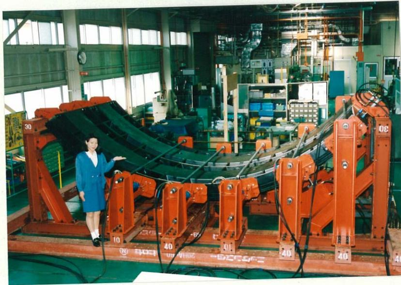
図 - 7.8 実物大のセグメントを用いた組立試験装置の全景
