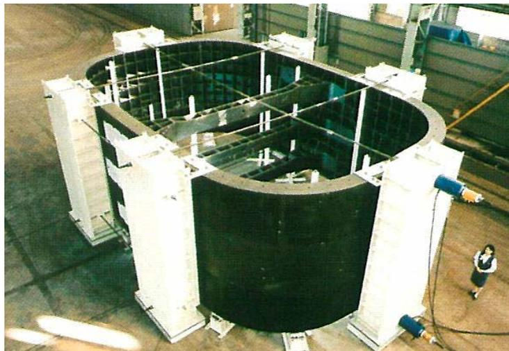
図 - 2.7 矩形シールド用セグメントのリング載荷試験状況
