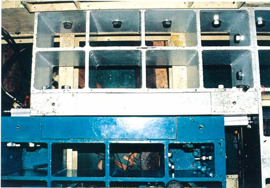
図 - 7.4 模型を用いた A セグメントの組立試験の状況 (下側が供試体)
