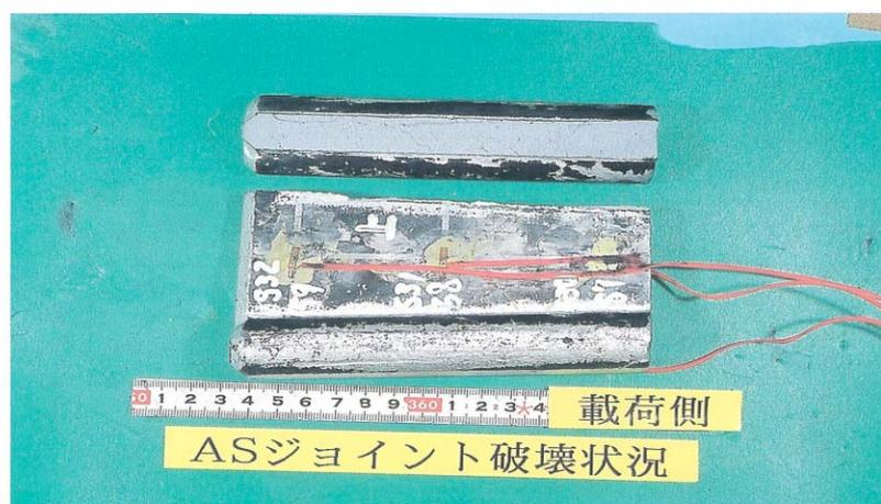
図 - 6.8 AS 金物の破壊状況
