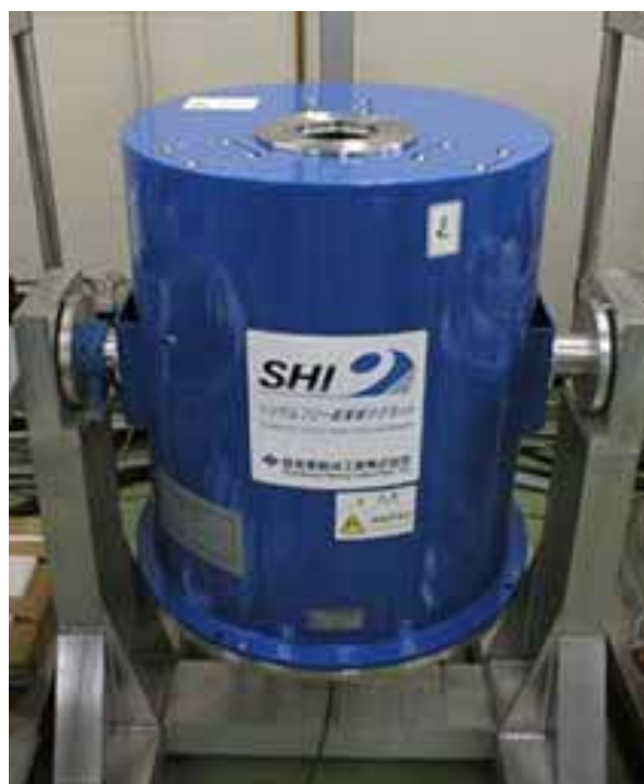
図 11 実験に使用した超電導磁石 ( HF10-100VHT, 住友重機械工業(株)製 )
