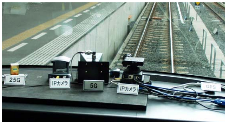
図 7-2-4 特急<いしづち>に設置した実験システムの一部 (中央が 5GHz 無線 LAN 用のホーンアンテナ)
