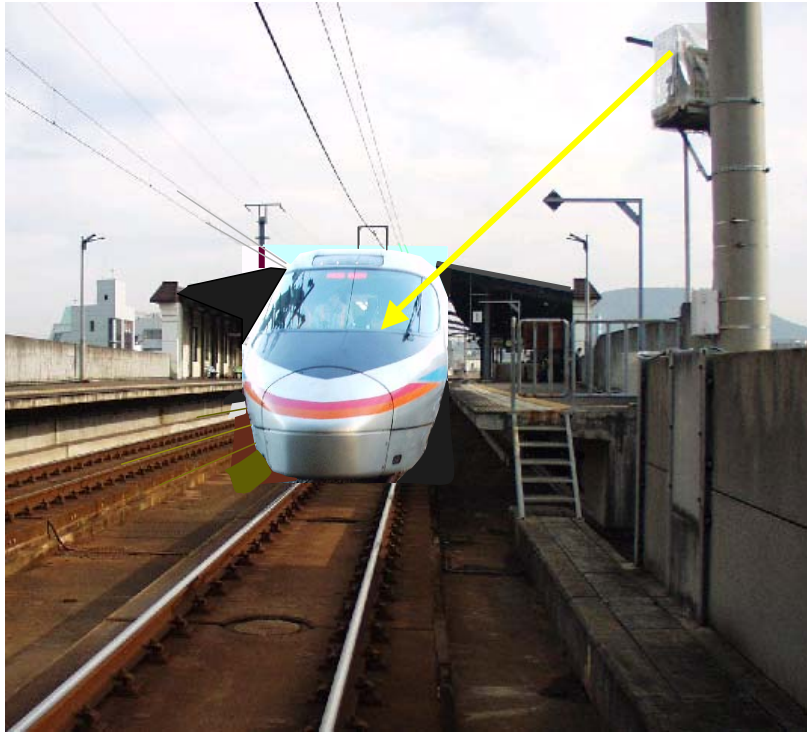
図 7-2-17 丸亀駅に設置の 25GHz 帯無線 LAN 基地局(右)と車載局アンテナ(矢印先) (列車側アンテナと基地局アンテナの距離は 10m)
