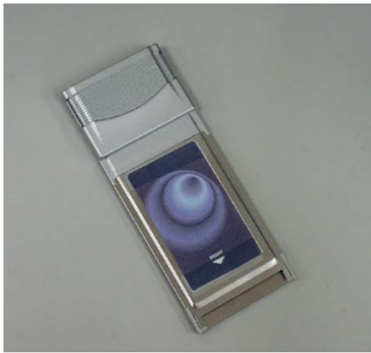
図 A6-3-2 著者らが開発した 5GHz 帯無線 LAN カードと仕様 (ARIB STD-T70 / HiSWANa)
