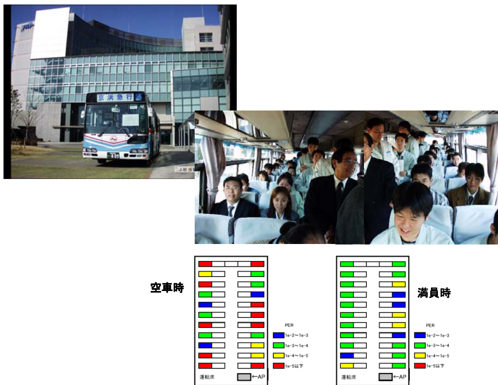
図 7-2-12 予備実験その2 列車内が満員の状況での無線 LAN の伝搬特性把握
