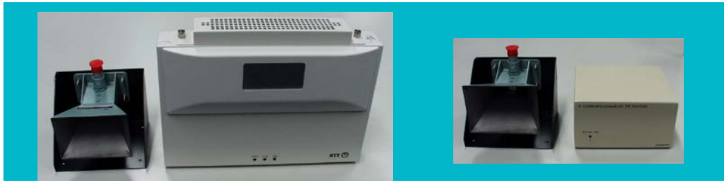
図 7-2-5 実験に使用した 5.03GHz 帯屋外用無線 LAN システム (左:基地局 右:車載(移動)局, いずれもアンテナは 10dBi ホーン型) (松下通信工業株式会社製)
