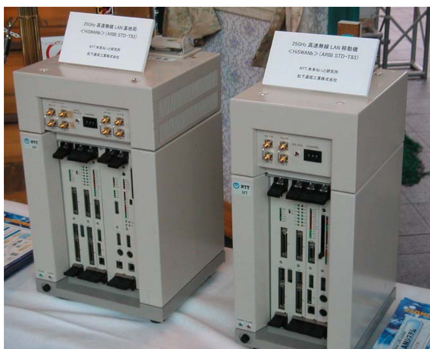
図 7-2-16 四国高松駅および丸亀駅に設置の 25GHz 帯無線 LAN 基地局(左)と 車載(移動)局(右)(松下通信工業株式会社製)
