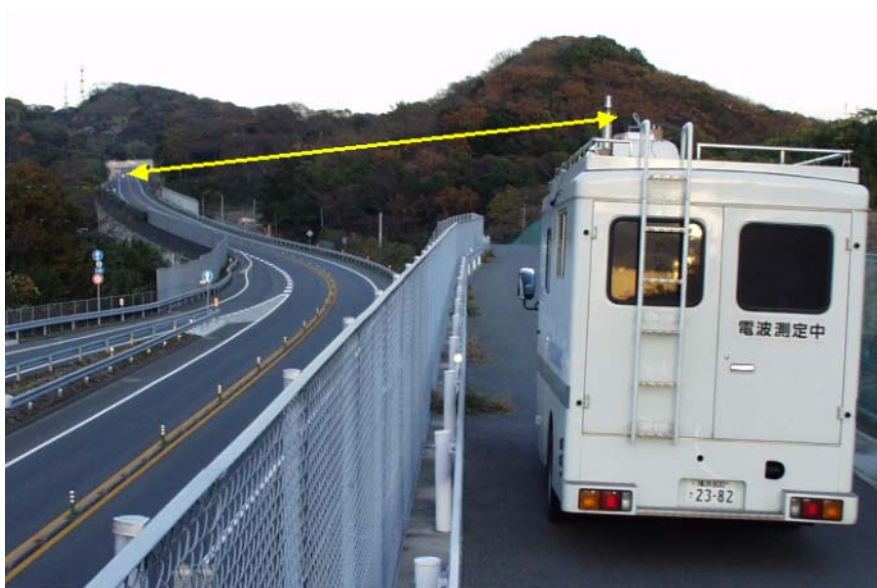
図 7-2-10 路車間通信で伝送速度の測定(横須賀三浦縦貫道)
