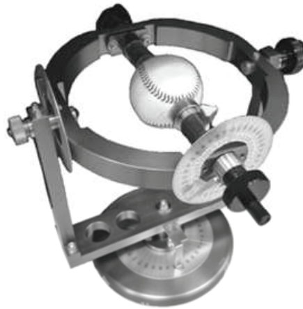
図 3-4 ボールの回転数を計測するためのジャイロスコープ
