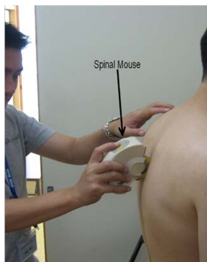
図 5 : Spinal Mouse による脊柱彎曲角測定 図に示すようなデバイスを脊椎棘突起に沿わせることで脊柱彎曲角が容易に測定することが可能である。
