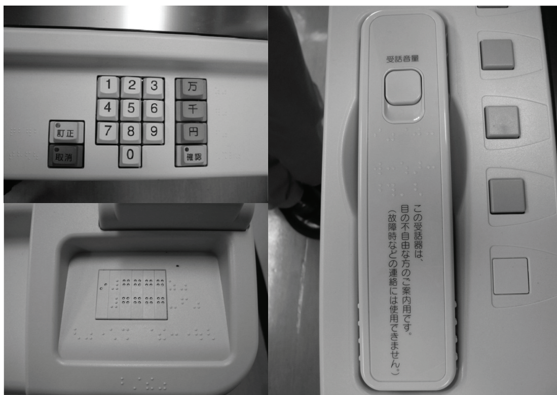
図 4.2 ゆうちょ銀行で使用される ATM の視覚障害者に対するアクセシビリティ
