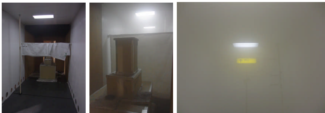
図 3.2.4-2 : スモークジェネレータの設置状況及び煙の発生状況
