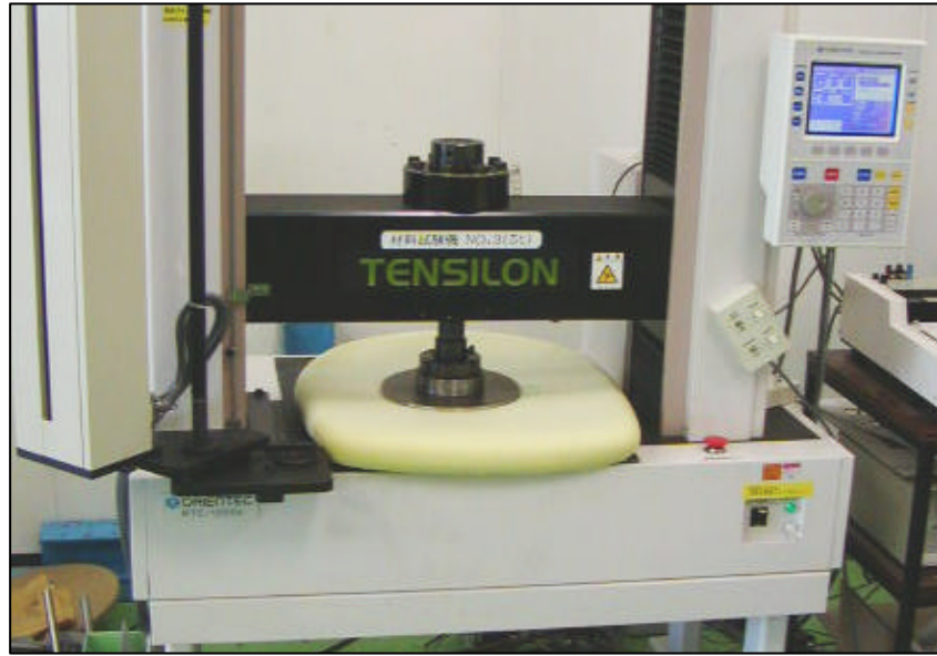
図 4.3 クッション材圧縮歪み試験
