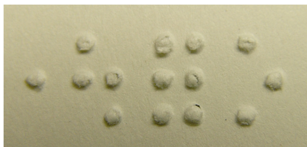
図1-13 エンボス印刷法による点字
