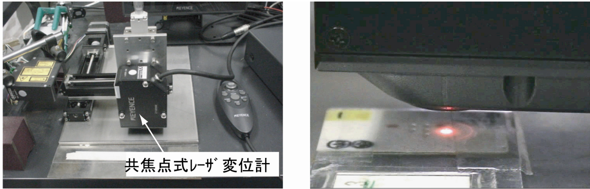
(a) 全体図 (b) 共焦点式レーザ変位計 図2-7 共焦点式レーザ変位計を備えたUV点字形状計測装置
