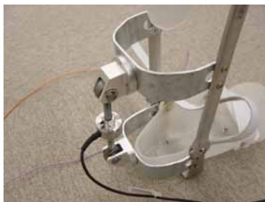
ロードセルを装具部品に取付けた状態
