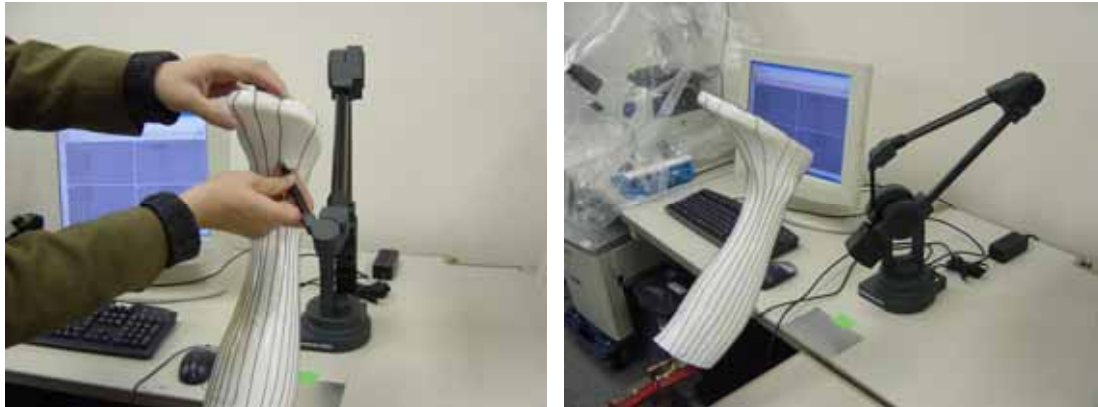
接触式測定器での装具のモデル化手法
