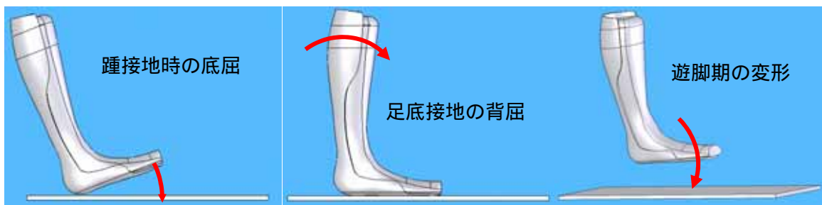
図 4.1 片麻痺者の歩行時の特徴点と装具の変形
